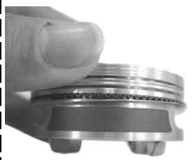
ピストン ピストン穴切り欠き サークリップの合い口
