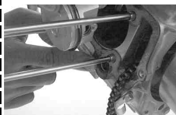
◇シリンダーガスケットとラバーパッキンを取り付ける。
