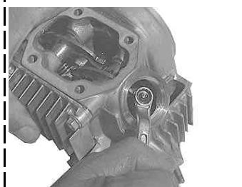
◇シリンダーヘッドに組まれているロッカーアームのタブットナットとボルトを取り外す。タブットナットを緩めた時点でタブットボルトをナットと一緒に取り外す。
