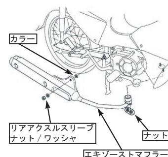
◇各部を規定トルクにて締め付ける。
