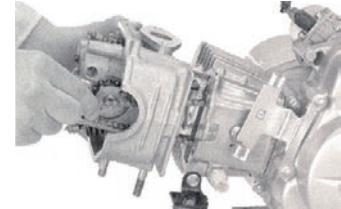
◇スプリングを取り付けたプランジャーをシリンダーへッドに取り付ける。
