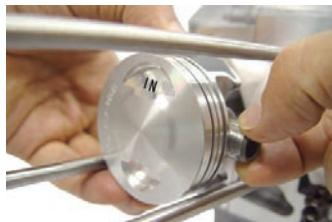
◇ピストンピンサークリップ溝にピストンピンサークリップを取り付ける。
