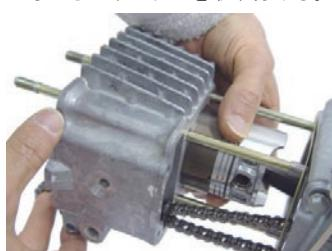
◇ガイドローラーを取り付け穴に合わせ、ガイドローラーボルト / シーリングワッシャを仮止めしておく。
