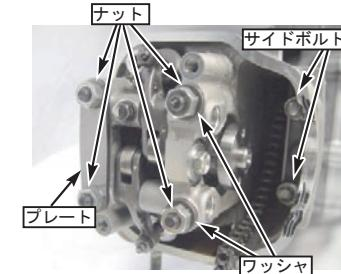
◇シリンダーへッドナット4個を対角に数回に分けて締め付け、規定トルクにて締め付ける。
