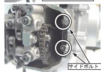
◇ガイドローラーボルトを緩めておく。シリンダーヘッドのサイドボルト2本を取り外す。
