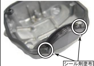
◇ヘッドカバー / ガスケットをヘッドカバーのボルト / マウントラバー2箇所にて取り付け、規定トルクにて締め付ける。
