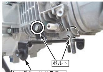
◇ワイヤーステーをボルト2本で取り付け、規定トルクにて締め付ける。
