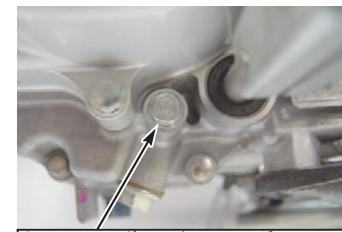
◇フライホイールの“T”マークがクラッチカバーの合わせマークに合っているか確認し、“O”マークを前方に向かって、タイミングマークがヘッドカバー取り付け面と合うようにカムスプロケットをカムチェーンに付け、カムシャフトに取り付ける。
