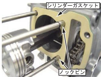
◇ピストンリング部にエンジンオイルを塗布し、なじませる。シリンダー内周部を清掃した後にエンジンオイルを塗布する。カムチェーンをシリンダーに通し、ピストンリングを指で圧縮しながらシリンダーを取り付ける。
