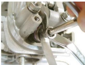
◇バルブクリアランス調整後、反時計方向にフライホイールを2回転した後で“T”マークとタイミングマークをそれぞれ合わせ、バルブクリアランスが変化していないか点検する。
