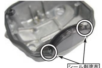
◇ヘッドカバー / ガスケットをヘッドカバーのボルト / マウントラバー 2箇所にて取り付け、規定トルクにて締め付ける。
