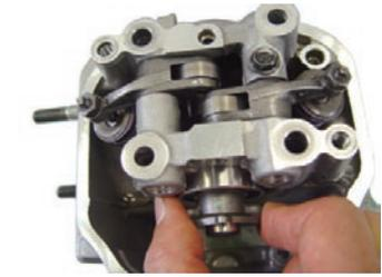
◇キットのカムシャフトのカム摺動部、ベアリング、デコンプカム部にエンジンオイルを塗布する。
