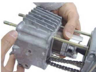
◇ガイドローラーをシリンダーの取り付け穴に合わせ、ガイドローラーボルト/シーリングワッシャを仮止めしておく。
