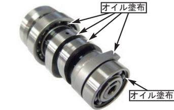
◇カム山を燃焼室に向け、且つデコンプカムの突起も燃焼室側を向くようにしてカムシャフトをシリンダーヘッドに取り付ける。
