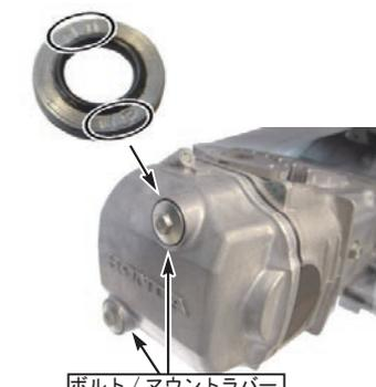
◇タイミングホールキャップ及びクランクシャフトホールキャップにOリングが付いている事を確認して取り付け、規定トルクにて締め付ける。
