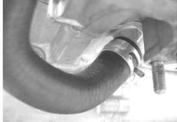
・ボルト、ワッシャ4本を取り外し、ラジエタートップカバーとラジエターを取り外す。
