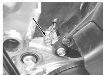
・O<sub>2</sub>センサーキャップを1/2回転以下回し、センサーから取り外す。スパークプラグキャップを取り外す。イグニッションコイルの配線2本の接続を外す。ボルト2本を取り外し、イグニッションコイルを取り外す。
