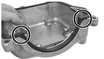
・ラバーシールがヘッドカバーの溝にしっかりとハマっているか確認し、3本のボルトにてシリンダーヘッドに取り付ける。
