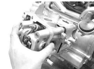
・ノックピン2個は再使用するので取り外しておく。カムチェーンガイドを取り外す。
