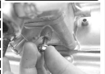
・ラジエーターにドレンボルト / Oリングを規定トルクにて締め付ける。
