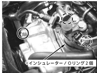
・コネクティングチューブからスロットルケーブルを外す。バンドのスクリューを緩め、コネクティングチューブからスロットルボディーを外す。車速センサーの3Pコブラーの接続を外す。
