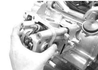
・ノックピン2個は再使用するので取り外しておく。カムチェーンガイドを取り外す。
