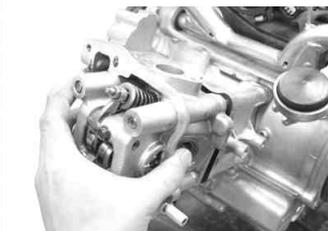
・ヘッドワッシャ4個、ヘッドナット4個を取り付け、対角に数回に分けて規定トルクにて締め付ける。サイドボルト2本を取り付ける。
