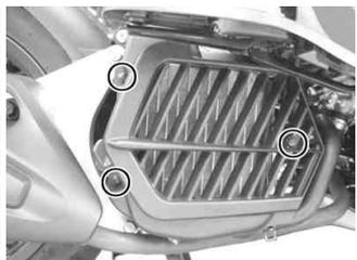
冷却水経路のエアは残っている場合があり、抜けるまで多少時間が掛かるため、リザーブタンクの液量の点検を随時行う事。
