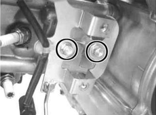
・クランクセンサー6Pカバーとコントロールユニットから3Pカバーの接続を外す。4ヶ所のバンドボスをフレームから外す。
