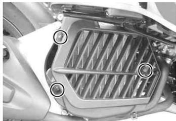
・ラジエターのキャップとドレンボルト/リングを取り外し、冷却水を排出する。排出後はキャップとドレンボルト/リングを仮止めし、異物の混入を防ぐ。
