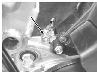
・O<sub>2</sub>センサーキャップを1/2回転以下回し、センサーから取り外す。スパークプラグキャップを取り外す。イグニッションコイルの配線2本の接続を外す。ボルト2本を取り外し、イグニッションコイルを取り外す。
