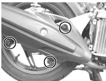
・シリンダーヘッド側のナット2個を仮止めする。
