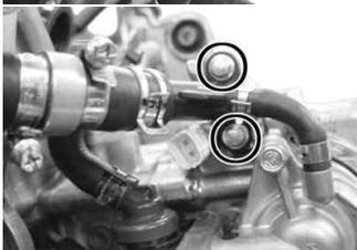
・ボルト、ワッシャ4本にてラジエター / ラジエターカバーを取り付ける。
