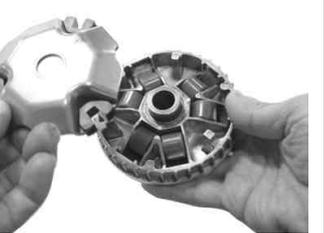
・ウエイトローラーが落下しないようにランププレートを押さえながらドライブフェイスボスと共にクランクシャフトに取り付ける。
