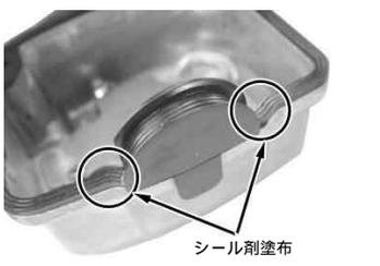
・シリンダーヘッドカバー/シールラバーをカバーボルト/マウントラバー2個にて取り付け、規定トルクにて締め付ける。
