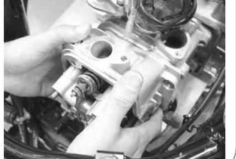
・ワッシャ4個、シリンダーヘッドナット4個を取り付け、シリンダーヘッドナットを対角に数回に分けて締め付け、規定トルクにて締め付ける。シリンダーヘッドのサイドボルト2本を交互に数回に分けて締め付け、規定トルクにて締め付ける。
