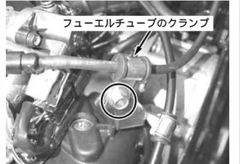
・ボルトを取り外し、ケーブルステアーをシリンダーヘッドから取り外し、スロットルケーブルのクランプを外す。
