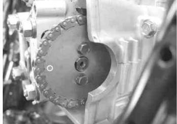
・テンショナーリフターのスクリーを取り外す。リフターを時計方向にいっぱいまで回し、ロックさせる。ボルト2本を取り外し、テンショナーリフターをシリンダーから取り外す。
