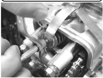
・フライホイールを時計方向に2回転まわし“T”マークをクランクケースの合わせマークに合わせ、バルブ隙間が変化していないか確認する。隙間が変化している場合は再度調整する。この作業を合うまで繰り返す。
