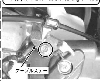
・油温センサーコードのクランプをシュラウドに取り付け、コードをエアシュラウドのフックに取り付け、油温センサーのカブラを接続する。
