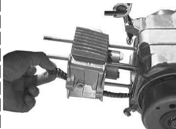
◇リングがシリンダーにはいたらカムチェーンをシリンダーに通しシリンダーをクランクケースにはめる。
