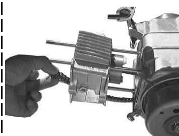
◇リングがシリンダーにはいたらカムチェーンをシリンダーに通しシリンダーをクランクケースにはめる。
