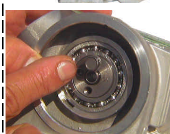
◇カムシャフトにカムスプロケットボルトを取り付け、引っ張るかプラスチックハンマーでヘッドを軽くたたくと抜けてくるので無理に引っ張らずカムシャフトを回しながら取り外す。
