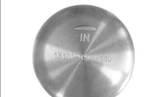
◇“IN”文字が上（インテーク側）になるようにピストンを取り付ける。
