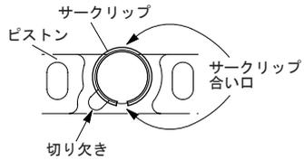
◇図を参考にしてピストンリングを取り付けます。
