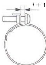
◇コネクティングチューブをスロットルボディに取り付け、バンドスクリューを確実に締め込みます。
