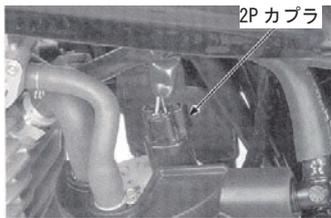
◇メインスイッチをONにしてキックスターターでエンジンを5回以上クランクしてフューエルホース内の燃圧を抜きます。
