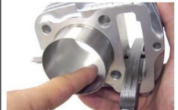
◇ピストンの全周面と、ピストンリングにエンジンオイルを塗布します。
