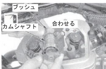
◇ノックピン2個を取り付け、写真の様にカムチェーンの中にカムシャフトをくぐらせておきます。
