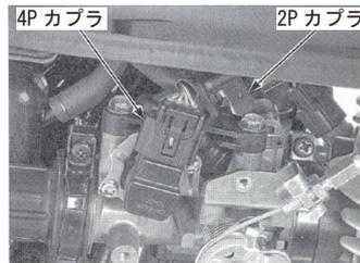
◇スロットルドラムカバーを取り付け、スクリューを規定トルクで締め付けます。
