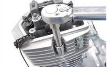
◇カムシャフトホルダーナット4個を対角に数回に分けて緩めてワッシャ4個、カムシャフトホルダー、カムシャフト、プッシュ、ノックピンを取り外します。
