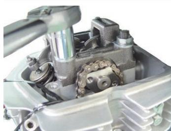
◇仮止めしていたシリンダーヘッドマウントボルトを本締めします。シリンダーヘッドマウントとカムシャフトの間にカムチェーンを噛み込まない様、注意して下さい。
