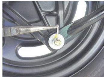
◇ナットを取り外し、ワッシャ、シートラバー、ストッパーアームボルトを取り外します。
