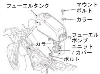
◇シート裏面前部のフックをフレームに差し込み、2本のボルト、カラーでフレームに取り付けます。
