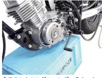
◇フロントエンジンハンガーのナット4個を取り外し、ボルト4本を抜き取ってフロントエンジンハンガーを取り外します。
