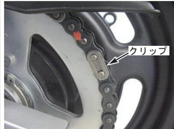
◇リンクプレートとマスターリンクを取り外し、ドライブチェーンを取り外します。
