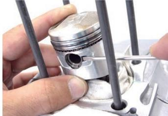
◇サークリップを取り外した方ヘドライバー等でピストンピンを押し外します。
