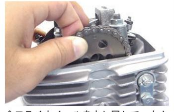
◇フライホイールを少し回して、カムプロケットを回し、六角ボルトを取り付けやすくします。
