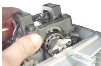
◇ワッシャ4個を取り付け、ナット4個を対角に数回に分けて均等に締め付けます。
