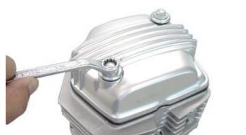
◇付属のシリンダーのボス部2箇所、オイルプラグボルト/シーリングワッシャを取り付けます。オイルプラグボルト M5 穴付きは、エンジン取り付け時に下側になるよう取り付けます。
