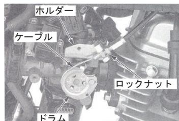
◇コネクティングチューブバンドスクリュー、及びインシュレーターバンドスクリューを緩め、スロットルボディを取り外します。
