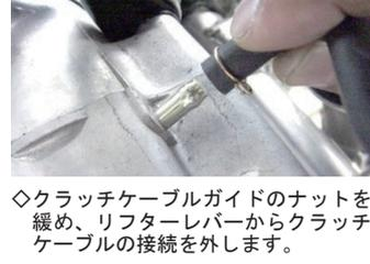
◇クラッチケーブルガイドのナットを緩め、リフターレバーからクラッチケーブルの接続を外します。
