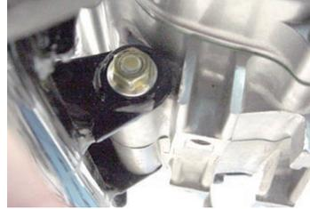
◇フロントエンジンハンガーを取り付け、ボルト4本を左側から差し込み、ナット4個を仮止めします。
