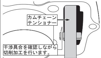
◇カムチェーンテンショナーをキットのシリンダーに差し込み、スプリングのフックをシリンダーに引っ掛けます。
