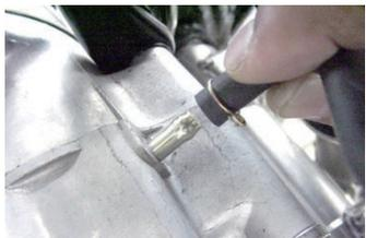
◇リフターレバーにクラッチケーブルを取り付け、クラッチケーブルガイドに取り付けてナットを締め付けます。
