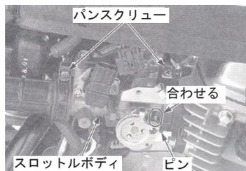
◇スロットルケーブルをスロットルドラムに接続し、ケーブルホルダーに取り付けます。
