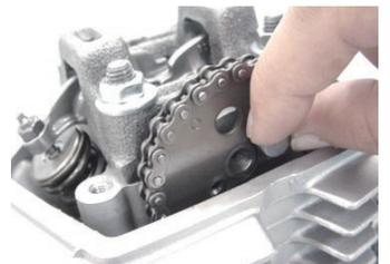
◇フライホイールを固定し、カムプロケットの六角ボルト2本を締め付けます。
