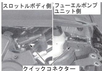
3. リテナータブを押し込んでロックタブをコネクタから外し、コネクタを引き抜きます。
