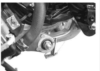
・フレーム下部にジャッキなどをかけ、リアショックを無負荷の状態にした後、リアショックのアップパーマウントナット/ワッシャ各2枚及びフロアアmountボルトを取り外し、リアショックを取り外す。エンジンハンガーボルトを抜き取り、エンジンをフレームから取り外す。
