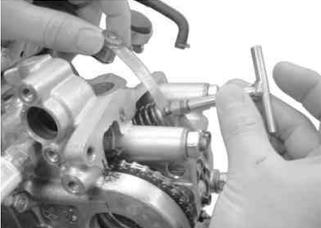
・タベット調整後、反時計方向にフライホイールを2回転し、再びクーリングファンの切り欠き部(Tマーク)とクランクケース、カムスプロケットの合わせマークとヘッド面がそれぞれ合い、且つKWNの文字がエンジン前方を向いている状態にする。
