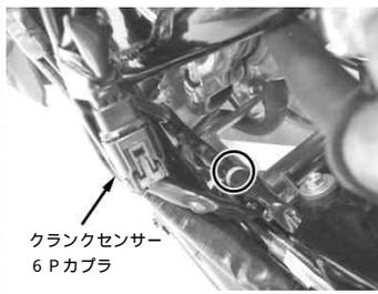
・エンジンコントロールユニット3P黒色カブラ、エンジンサブハーネス10Pカブラ、エンジンサブハーネス6P黒色カブラをそれぞれ接続する。アースケーブルをボルトにて取り付ける。
