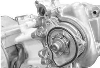
・ウォーターポンプカバーにノックピン2個が付いている事を確認し、各ホースやラジエターと共にエンジンに取り付ける。
