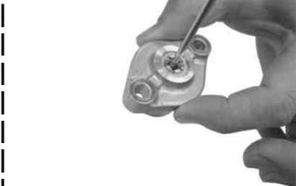
・カムチェーンテンショナーに付属のガスケットを取り付け、ボルト2本にてシリンダーに取り付ける。
