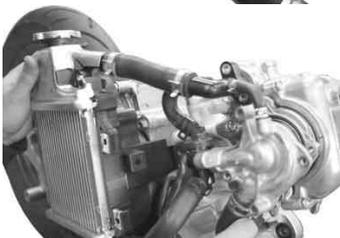
・ウォーターポンプカバーをマウントボルト3本、カバーボルト1本にて取り付ける。ウォーターホースジョイントを2本のボルトにて取り付ける。
