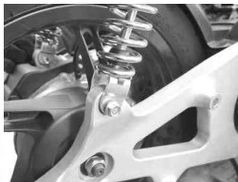
・センタースタンドを立て、車体を安定させた後に仮止め部を規定トルクにて締め付ける。
