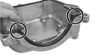
・ラバーシールがヘッドカバーの溝にしっかりとハマっていることを確認し、4本のボルトにてシリンダーヘッドに取り付ける。
