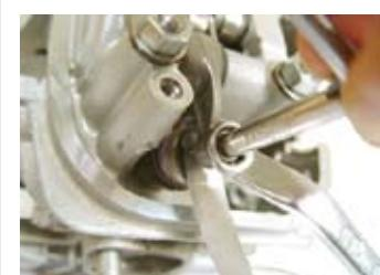
◇バルブクリアランス調整後、反時計方向にフライホイールを2回転回した後で“T”マークとタイミングマークをそれぞれ合わせ、バルブクリアランスが変化していないか点検する。
