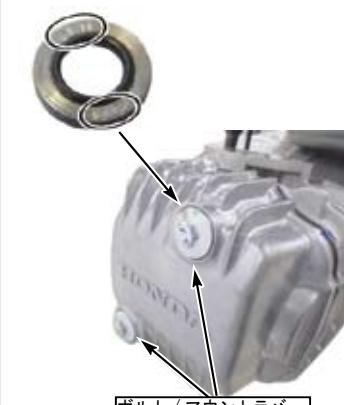
◇タイミングホールキャップ及びクラシックシャフトホールキャップに0リングが付いている事を確認して取り付け、規定トルクにて締め付ける。
