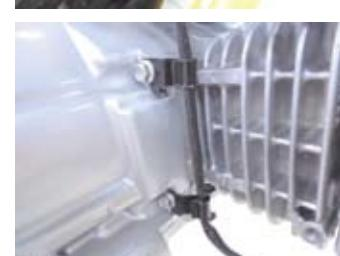
◇レッグシールドステーをボルト2本で取り付け、規定トルクにて締め付ける（スーパーカブ110の場合）。
