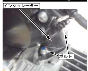
◇エアクリーナーケースをボルト2本にてフレームに取り付ける。ワイヤーハーネスクランプを取り付ける。
