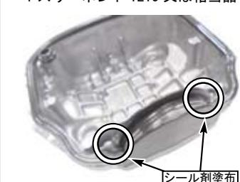
◇ヘッドカバー / ガスケットをヘッドカバーのボルト / マウントラバー2箇所にて取り付け、規定トルクにて締め付ける。
