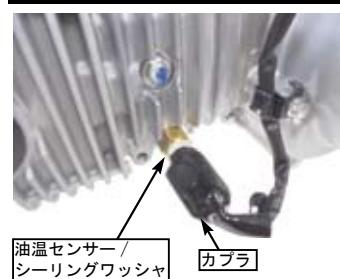
◇ボルトにてセンサーガードをシリンダーに取り付け、配線クランプを取り付ける（クロスカブ110の場合）。
