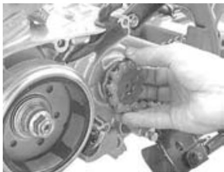
ドライブチェーンに適度なたるみを持たせたまま、仮止めしたリアエンジンハンガーのナット 2 個と、フロントエンジンハンガープレートのナット 4 個を取り付けます。
