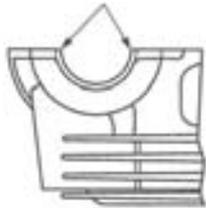
マウントラバー 4 枚を“UP”マークが上に向くようにして取り付けます。
