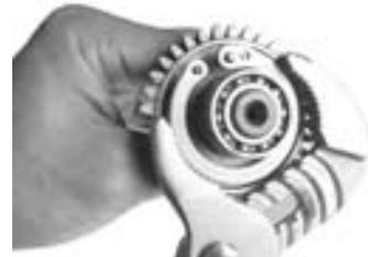
サブギアをはめ込み、ノーマルのピンBを挿し込みます。
