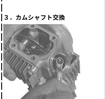
◇シリンダーヘッドに組まれているロッカーアームのタペットナットとボルトを取り外す。タペットナットを緩めた時点でタペットボルトをナットと一緒に取り外す。 使用工具 オフセットレンチ 9mm
