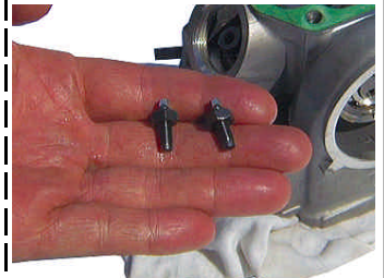
◇シリンダーヘッドに組まれているロッカーアームのタペットナットとボルトを取り外す。タペットナットを緩めた時点でタペットボルトをナットと一緒に取り外す。 使用工具 オフセットレンチ 9mm
