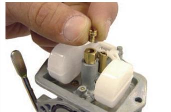
◇フロートチャンバーを取り付け、2本のスクリーでキャブレターに取り付けます。
