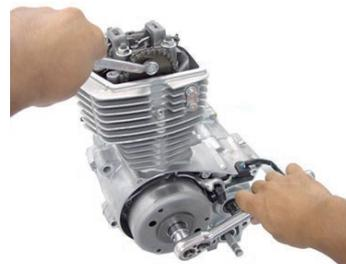
◇ロックボルトとセットプレートを取り外し、アジャスターを取り外します。
