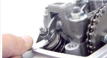
◇引き抜くときに少し抵抗があるぐらいにアジャストスクリューを合わせ、ナットを締め付けます。
