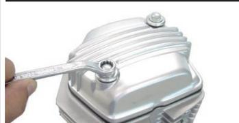
◇付属のシリンダーのボス部2箇所、オイルプラグボルト/シーリングワッシャを取り付けます。オイルプラグボルト M5 穴付きは、エンジン取り付け時に下側になるよう取り付けます。
