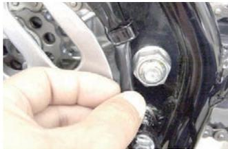
◇ボルト2本を取り外し、L. ステップを取り外します。
