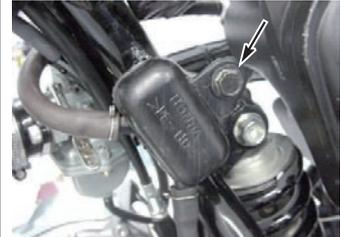
◇キャブレターのチョークレバーを引いて全閉にし、ストレージタンクチューブとチョークレバーが干渉しない位置にストレージタンクを動かし、ボルトを締め付けます。
