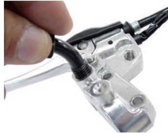
◇スロットルケーブルをスロットロパイプに接続します。
