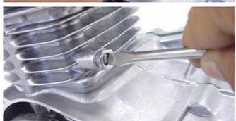
◇マイナスドライバーでアジャストボルトを固定し、ロックナットを締め付けます。
