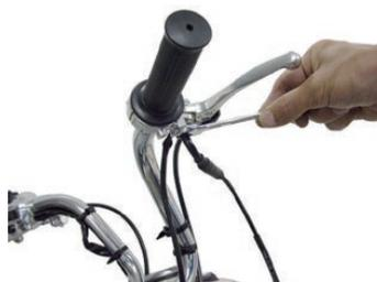
◇スクリー2本を外し、アッパースロットルハウジングを取り外します。
