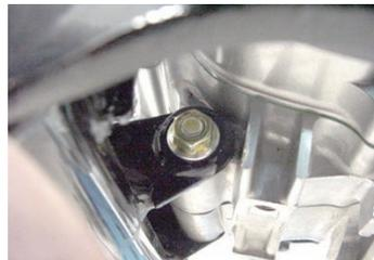
◇まず、上側のボルトを抜き取り、カラーとクラッチケーブルガイドを取り外します。
