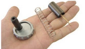
◇スロットルケーブルにトップカバーを取り付け、スプリングを入れてインテークケーブルにスロットルバルブを取り付けます。
