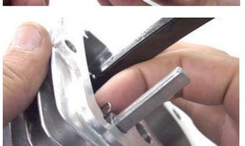
◇カムチェーンテンショナーのロッド先端を取り付け面と同じぐらいの位置にします。アジャストボルトで固定し、ロックナットを締め付けます。
