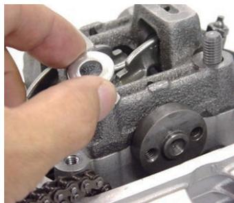
◇ナット4個を対角に数回に分けて均等に締め付けます。
