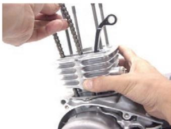
◇カムチェーンガイドの先端をクランクケースの溝に、突起部をシリンダーの溝に合わせようとして差し込みます。
