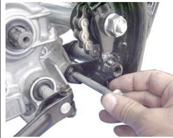
◇カラーとクラッチケーブルガイドを取り付け、リアエンジンマウントの上側にボルトを左側から差し込みます。
