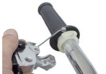
◇ロアスロットルハウジングからスロットルケーブルを取り外します。
