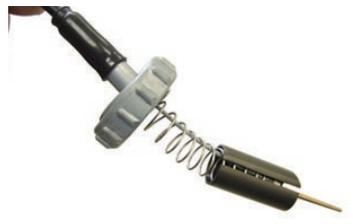
◇スロットルバルブの切り欠き部をスロットルストップスクリューに合わせてキャブレターに差し込みます。
