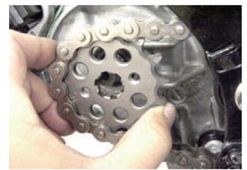
◇ドライブチェーンに適度なたるみを持たせたまま、仮止めしたリアエンジンマウントのナット2個と、フロントエンジンハンガープレートのナット4個を本締めします。
