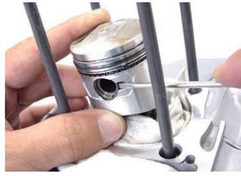
◇サークリップを取り外した方ヘドライバー等でピストンピンを押し外します。
