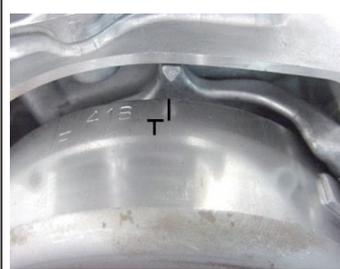
◇カムプロケットの“O”マークが真上を向くようにカムチェーンを取り付けます。カムプロケットをカムシャフトにはめ込みます。
