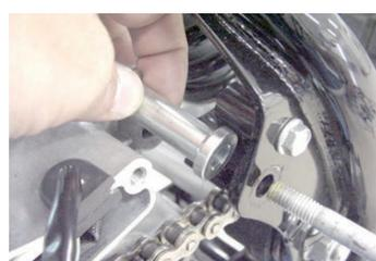
◇下側のボルトを抜き取り、エンジンをフレームの左側から取り外します。フレーム等に傷をつけないように注意して下さい。
