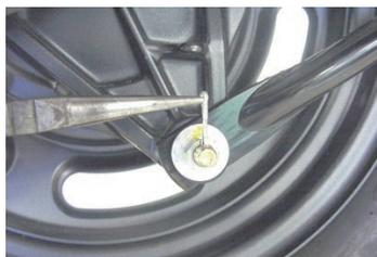
◇ナットを取り外し、ワッシャ、シートラバー、ストッパーアームボルトを取り外します。
