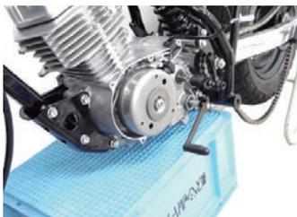
◇フロントエンジンハンガーのナット4個を取り外し、ボルト4本を抜き取ってフロントエンジンハンガーを取り外します。
