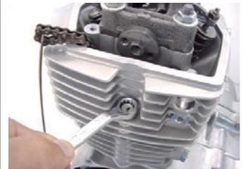
◇カムシャフトホルダーナット4個を対角に数回に分けて緩めてワッシャ4個、カムシャフトホルダー、カムシャフト、ノックピンを取り外します。
