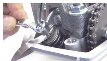
◇ナットを締め付け後、0.1mmのシクネスゲージを再度差し込み、バルブ隙間を確認します。
