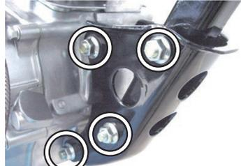
◇リアエンジンマウントの上側のナットを取り外します。
