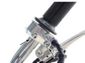
◇スロットルパイプからスロットルケーブルのインナーの接続を外します。
