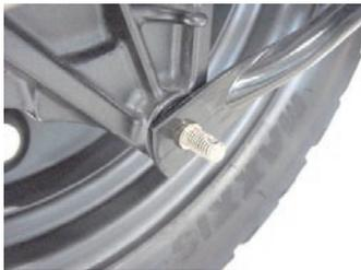
◇シートラバー、ワッシャの順に取り付け、ナットを取り付けます。
