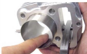
◇ピストンの全周面と、ピストンリングにエンジンオイルを塗布します。
