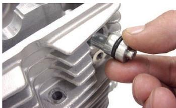
◇ロックボルトでセットプレートを取り止めます。
