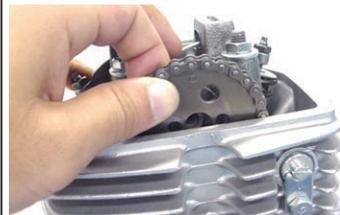
◇フライホイールを少し回して、カムプロケットを回し、6角ボルトを取り付けやすくします。
