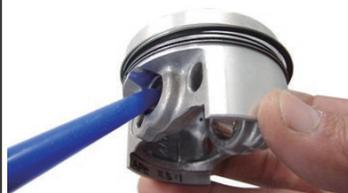
◇コンロッドのピストンピン穴にエンジンオイルを塗布します。
