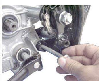
◇カラーとクラッチケーブルガイドを取り付け、リアエンジンマウントの上側にボルトを左側から差し込みます。
