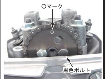
◇フライホイールを固定し、カムスプロケットの六角ボルト2本を締め付けます。
