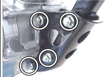
◇リアエンジンマウントの上側のナットを取り外します。
