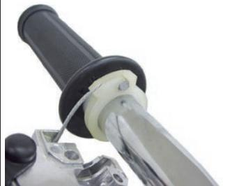
◇アッパースロットルハウジングを2本のスクリューで取り付けます。
