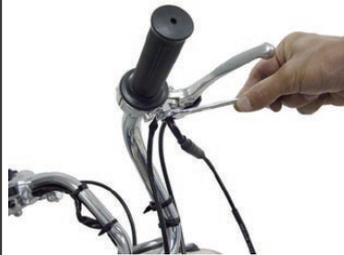
◇スクリュー2本を外し、アッパースロットルハウジングを取り外します。
