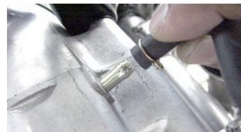
◇クラッチケーブルガイドのナットを緩め、リフターレバーからクラッチケーブルの接続を外します。
