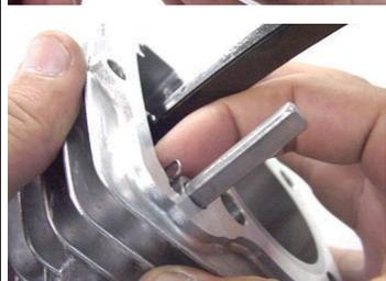
◇カムチェーンテンショナーのロッド先端を取り付け面と同じぐらいの位置にします。アジャストボルトで固定し、ロックナットを締め付けます。
