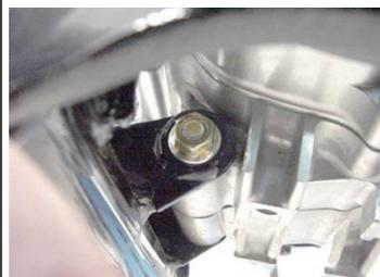
◇まず、上側のボルトを抜き取り、カラーとクラッチケーブルガイドを取り外します。
