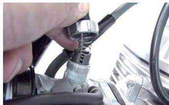
◇コンプレッションスプリングを圧縮してスロットルケーブルをスロットルバルブから取り外します。
