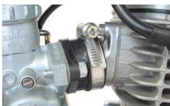
◇コネクティングチューブをキャブレターに差し込み、バンドのスクリューを締め付けます。
