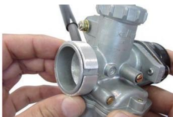
◇バンドをインシュレーターに付け、インテークマニホールドに差し込みます。バンドを締め付けます。
