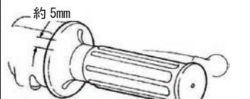
◇アジャスターを固定し、6角ナットを締め付けます。
