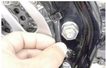
◇ボルト2本を取り外し、L. ステップを取り外します。
