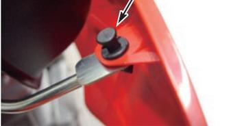
◇シート裏面の前部2ヶ所のフックをそれぞれ フューエルタンク、フレームに差し込み、シート裏側後部のボルトをフレームに差し込みます。シート裏側のナット、リアフェンダーの左右のボルトを取り付けます。
