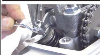
◇ナットを締め付け後、0.1mmのシクネスゲージを再度差し込み、バルブ隙間を確認します。
