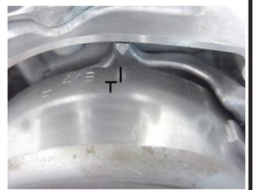
◇カムスプロケットの“O”マークが真上を向くようにカムチェーンを取り付けます。カムスプロケットをカムシャフトにはめ込みます。
