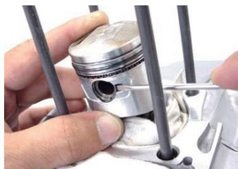
◇サークリップを取り外した方ドライバ等でピストンピンを押し外します。
