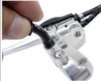
◇スロットルケーブルをスロットルパイプに接続します。
