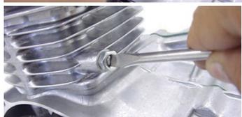
◇マイナスドライバーでアジャストボルトを固定し、ロックナットを締め付けます。
