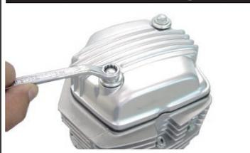
◇付属のシリンダーのボス部2箇所、オイルプラグボルト/シーリングワッシャを取り付けます。オイルプラグボルト M5 穴付きは、エンジン取り付け時に下側になるよう取り付けます。
