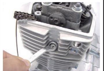
◇カムシャフトホルダーナット4個を対角に数回に分けて緩めてワッシャ4個、カムシャフトホルダー、カムシャフト、ノックピンを取り外します。
