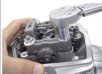
◇仮止めしていたシリンダーヘッドマウントボルトを本締めします。
