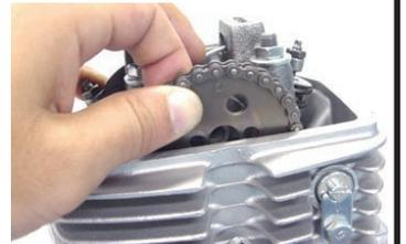
◇フライホイールを少し回して、カムスプロケットを回し、六角ボルトを取り付けやすくします。
