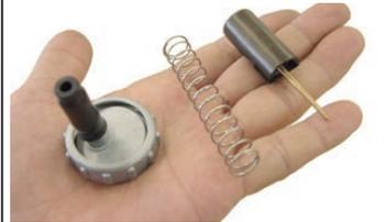
◇スロットルケーブルにトップカバーを取り付け、スプリングを入れてインナーケーブルにスロットルバルブを取り付けます。
