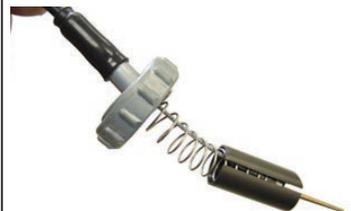
◇スロットルバルブの切り欠き部をスロットルストップスクリューに合わせ、キャブレターに差し込みます。
