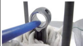
◇ピストンピンにエンジンオイルを塗布し、ピストンの上面の矢印が、前(排気側)を向くようにピストンを取り付けます。
