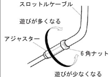
◇スロットルグリップ部で5mm程度の遊びになるように調整して下さい。
