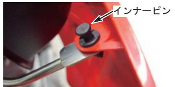
◇ボルトを取り外して、フューエルタンク後部を少し持ち上げ、後方にスライドさせて取り外します。
