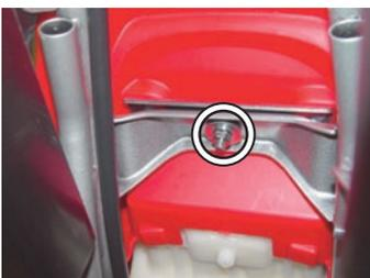
◇フューエルロックにフューエルチューブを接続し、チューブクリップで固定します。
