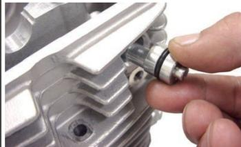
◇ロックボルトでセットプレートを取り付けます。
