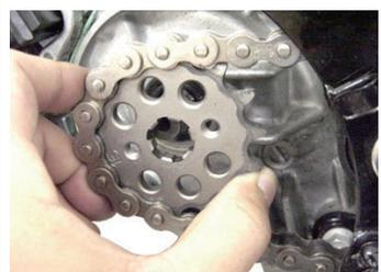
◇ドライブチェーンに適度なたるみを持たせたまま、仮り止めたリアエンジンマウントのナット2個と、フロントエンジンハンガープレートのナット4個を本締めします。
