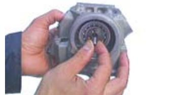
◇ロッカーアームのタペットスクリューを時計方向に回して取り付ける。
