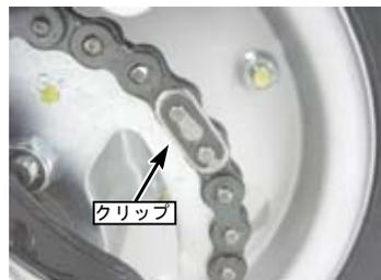
◇リンクプレートとマスターリンクを取り外し、ドライブチェーンを取り外す。
