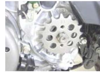
◇キットのプレートを取り付け、ボルト2本を仮止めする。
