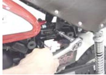
◇リアショックのナット2個を締め付ける。
