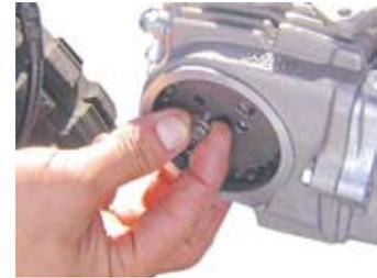
◇フライホイールを固定してカムプロケットボルトを2本締め付ける。
