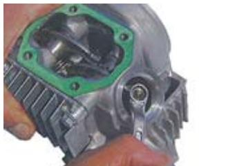
◇カムシャフトにカムスプロケットボルトを取り付け、引っ張るかプラスチックハンマーでヘッドを軽くたたくと抜けてくるので無理に引っ張らずカムシャフトを回しながら取り外す。
