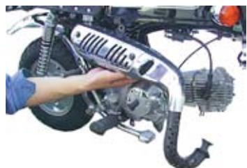
◇フランジのカラー2個をエキゾーストパイプを挟み込むようにして取り付け。
