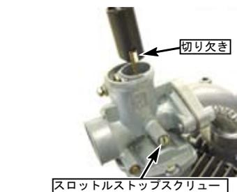
◇キャブレターのくぼみにトップキャップの凸を合わせて取り付ける。
