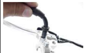
◇キット内のスロットルケーブルをロアスロットルハウジングに取り付ける。
