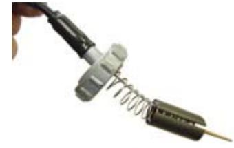
◇スロットルバルブの切り欠き部をスロットルストップスクリューに合わせてキャブレターに差し込み、取り付ける。
