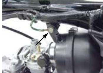
◇インレットパイプをシリンダーヘッドに止めているボルト2本を取り外しインレットパイプ、キャブレター、エアクリーナーを取り外す。
