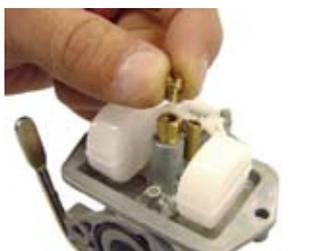
◇フロートチャンバーを取り付け、2本のスクリューでキャブレターに取り付ける。
