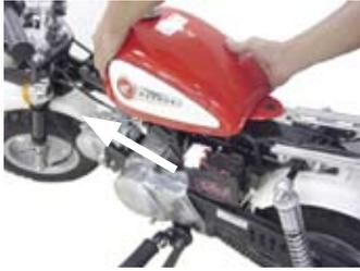
◇フューエルタンクをフレームにボルトで取り付ける。
