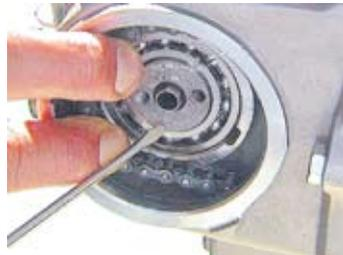
◇チェンジペダルのシャフトの横にある6角ボルトを取り外す。
