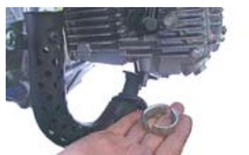
◇EXパイプ部のナット2個を締める。(仮止め)
