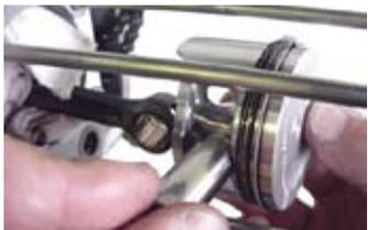
◇付属のピストンピンサークリップをサークリップ溝にきっちりはめ込む。この時、サークリップの合い口は切り欠き部を避けて、ピストン上下方向に向けて取り付ける。
