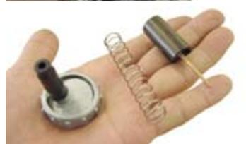
◇スロットルケーブルにトップキャップを取り付け、スプリングを入れてインナーケーブルにスロットルバルブを取り付ける。
