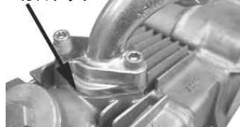
インレットパイプ ガスケット
