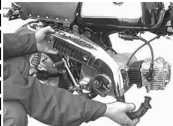
◇アース線をエアクリーナーステー部のボルトでフレームに取り付ける。
