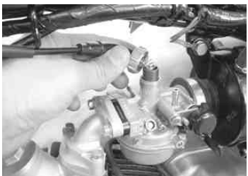
◇キャブレターのトップキャップを外し、スロットバルブをキャブレターから抜き取る。
