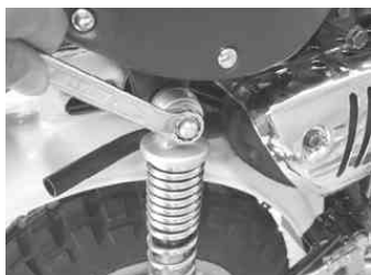
◇シート下のナットを緩め、ボルトを取り外す。
