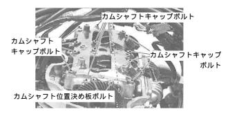
シリンダーヘッドボルトを取り外し、シリンダーヘッドを取り外す。 シリンダーヘッドボルトを緩める際は浮き出し文字の8から1の番号順 に緩めます。
