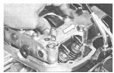
調整が完了すればスライドさせたロッカーアームを必ず元に戻して下さ
