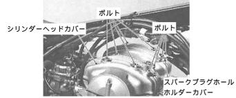
カムシャフトを取り外す為、タイミング点検プラグ及びロータボルトプラグを取り外し、ロータボルトを反時計方向に回しピストンをTDCに合わせます。
