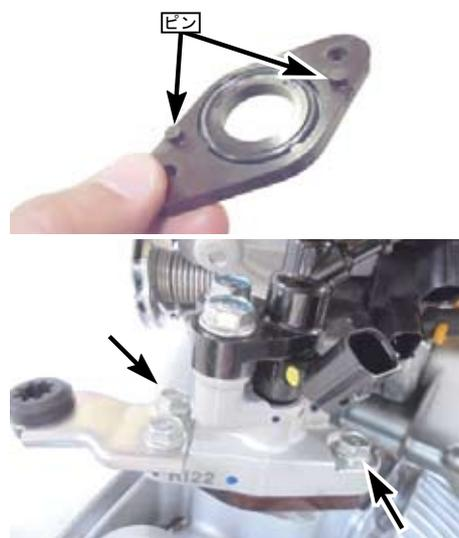
・スロットルドラムカバーをボルトワッシャにて取り付け。
