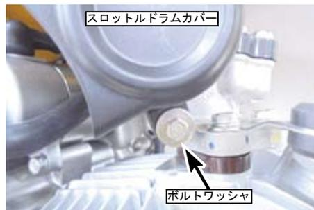
・スロットルケーブルをボルトにてフレームに取り付ける。
