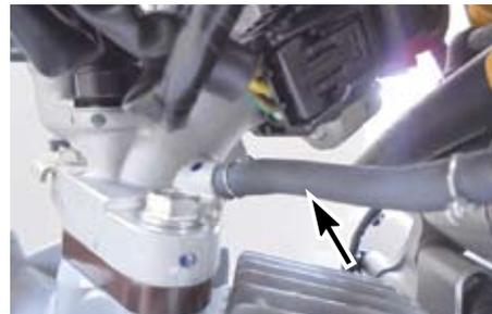
・ボスをグロメットに差し込みながらエアクリナーケースをセットする。コネクティングチューブをスロットルボディーに確実に差し込み、コネクティングチューブバンドのスクリューを締め付ける。エアクリナーケースをフレームにとめている3本のボルトを仮止めした後、規定トルクにて締め付ける。コネクティングチューブにハイテンションコードをセットする。クランクケースブリーザホースとフューエルブリーザホース、吸気温センサーのカブラを接続する（タイモデルは除く）。
