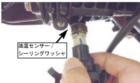
・油温センサーガードをボルト1本にてシリンダーに取り付ける。
