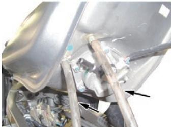
・ボルト1本で燃料タンクを取り付ける。
