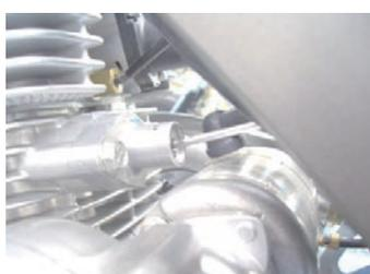
・ロッドを保持していたドライバーを取り外しキャップを取り付ける。
