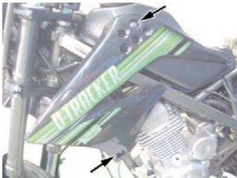
・ボルト各1本で左右のサイドカバーを取り付ける。
