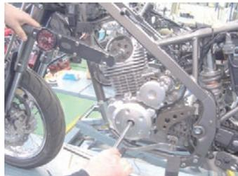
・カムシャフトチェーンテンショナーのブッシュロッドを圧縮しながらロッドが止まるまで細長のドライバーで時計回りに回す。
