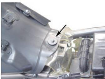
・燃料ポンプリード線とエンジン温度センサーリード線の2ヶ所のコネクタを接続し、クランプにて固定する。
