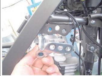
・先にシリンダーヘッド側のボルトとナットを締め付ける。
