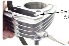
詰めていたウエスを取り外します。クランクケースとシリンダーの合せ面をシンナー等で脱脂します。
