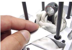
ピストンピン穴の片側に付属のピストンピンサークリップを取り付けます。
