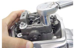
仮止めしていたシリンダーヘッドマウントボルトを本締めします。
