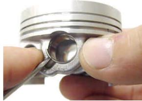
図を参考にしてN文字を上に向けピストンリングを取り付けます。ピストンリングの色
