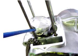
シリンダーにピストンリングの合い口がずれないようシリンダーを取り付けます。
