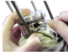
カムチェーンテンショナーをキットのシリンダーに差し込み、スプリングのフックをシリンダーに引っ掛けます。
