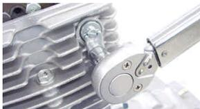
アジャスターの調整だけではガタが無くない場合、シリンダーのアジャストボルトで調整を行います。
