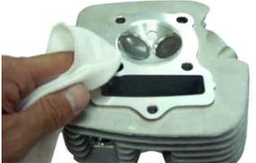
ノックピン2個とシリンダーヘッドガスケットをシリンダーに取り付けます。
