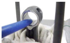
ピストンピンにエンジンオイルを塗布し、ピストンの上面のINが、後(吸気側)を向くようにピストンを取り付けます。
