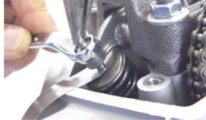
ナットを締め付け後、0.05 mmのシクネスゲージを再度差し込み、バルブ隙間を確認します。シリンダーヘッドのオイル溜りにきれいなエンジンオイルを入れます。
