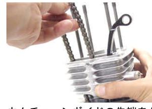
カムチェーンガイドの先端部をクランクケースの溝に、突起部をシリンダーの溝に合わずようにして差し込みます。
