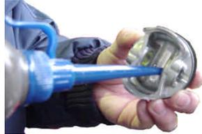
コンロッドのピストンピン穴にエンジンオイルを塗布します。
