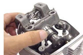
ワッシャ4個を取り付け、ナット4個を対角に数回に分けて均等に締め付けます。
