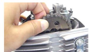
カムシャフトのボルト穴をカムスプロケットに合わせて六角ボルト2本を、仮止めします。
