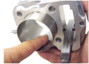
ピストンの全周面と、ピストンリングにエンジンオイルを塗布します。
