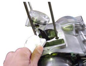
ノックピン2個とシリンダーガスケットをクランクケースに取り付けます。
