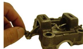
キットのカムシャフトのジャーナル面とカム面にエンジンオイルを塗布し、カムシャフトのカム山は下側に向けシリンダーヘッドに取り付けます。
