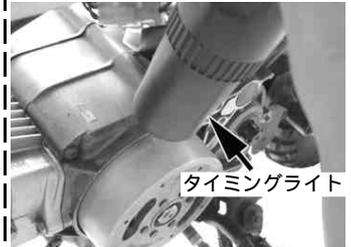
タイミングライト(00-01-009)を用いて、アイドリング時にフライホイールの'F'マークとクランクケースの合わせマークとが合っているか確認する。
