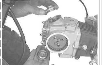
タペットキャップ2個を反時計方向に回し取り外す。
