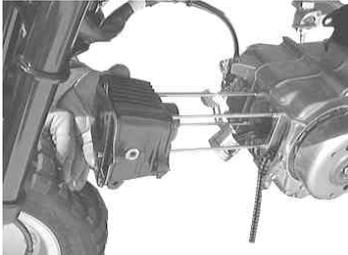
ピストンが抜けたらタイヤを手で押さえながらシリンダーを前方へ取り外す。
