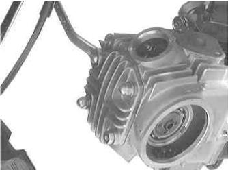
シリンダーヘッドカバーを止めているナット4個を対角の順番に反時計方向へ回し取り外す。ナット下にあるワッシャー4枚を取り外す。
