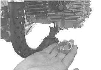
フランジのカラー2個をエキゾーストパイプを挟み込むようにして取り付け。
