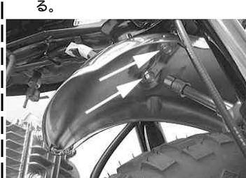
フロントフェンダー裏側の六角ボルト2本を締めて取り付け。
