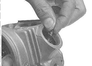
ロッカーアームのタベットスクリューを時計方向に回して取り付ける。
