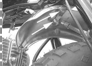
フロントフェンダー裏側の6角ボルト2本を反時計方向に回し取り外す。
