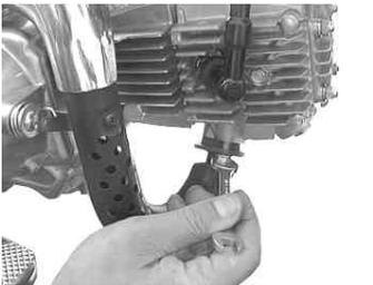
E Xパイプ部のナット2個を締める。(仮止め)
