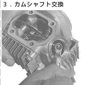
シリンダーヘッドに組まれているロッカーアームのタベットナットとボルトを緩める。タベットナットを緩めた時点でタベットボルトをナットと一緒に取り外す。
