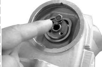
カムシャフトにカムスプロケットボルトを取り付け、引っ張るかプラスチックハンマーでヘッドを軽くたたくと抜けてくるので無理に引っ張らずカムシャフトを回しながら取り外す。
