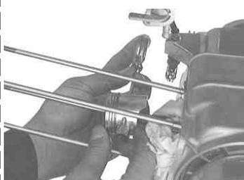
ピストンピンをピストンサークリップが付いていない方向へ取り外す。ピストンサークリップの付いている方向からマイナスドライバーで押し上げると簡単にとれます。
