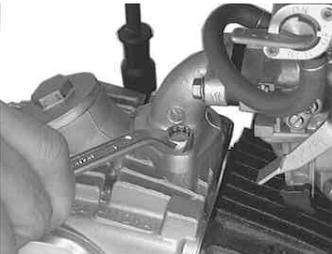
シリンダーヘッドとインレットパイプを止めているボルト2本を反時計方向に回し取り外す。
