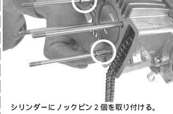
シリンダーにノックピン2個を取り付ける。
