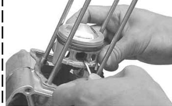
ドライバーでピストンにキズを付けないように押し込むと比較的簡単に取り付けられます。押し込み中にサークリップが外れて飛んでしまうことがあるので慎重に行ってください。目に入らぬように防護メガなどを着用して下さい。詰っていたウエスを取り外す。
