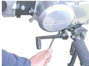
◇クランクケース左カバーを止めているボルト3本を反時計方向に回し取り外す。
