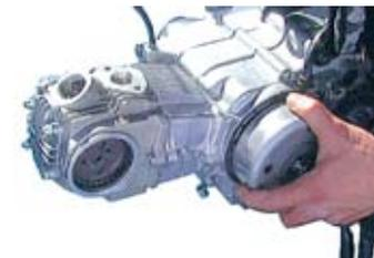
◇タペットすき間が変化していないか点検し、隙間が合っていればOK、くるっている場合は調整する。
