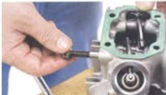
◇カムシャフトにカムスプロケットボルトを取り付け、引っ張るかプラスチックハンマーでヘッドを軽くたたくと抜けてくるので無理に引っ張らずカムシャフトを回しながら取り外す。
