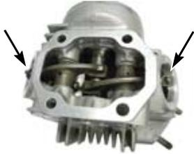
◇M8のボルトを取り付けてロッカーアームシャフトを抜き取り、ロッカーアームを取り外す。これらのパーツはインテーク側、エキゾースト側が分かる様にしておく。
