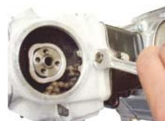
◇シリンダーのガイドローラーボルトとシリンダーとクランクケース間のサイドボルトを反時計方向に回し緩める。
