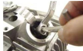
◇タペット調整後、反時計方向にフライホイールを2回転手で回した後でTマークとOマークを合わせる。
