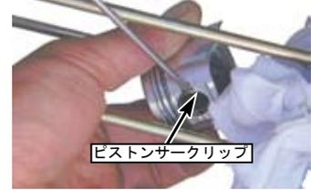
◇ピストンピンをピストンサークリップが付いていない方向へ取り外す。ピストンサークリップの付いている方向からマイナスドライバーで押すと簡単にとれる。
