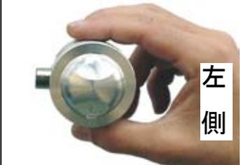
◇ドライバーでピストンにキズを付けないように押し込むと比較的簡単に取り付けられる。
