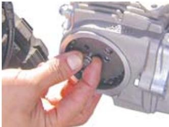
◇フライホイールを固定してカムスプロケットボルトを3本締め付ける。
