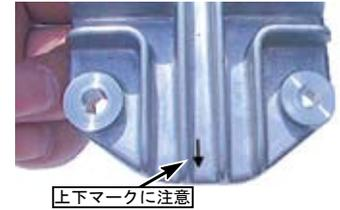
◇ヘッドカバーのワッシャとナットを取り付ける。(エンジンを前から見て左下が銅ワッシャ残りの3つは鉄ワッシャ、右下が六角ナット残りの3つがキャップナット)
