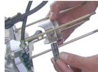
◇付属のピストンピンサークリップをサークリップ溝にきっちりはめ込む。
