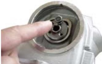
◇バルブスプリングコンプレッサーを用い、ノーマルのバルブスプリングをインテーク側、エキゾースト側共に付属の物に変更する。
