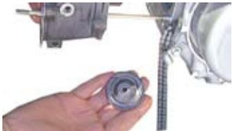
◇ピストンが抜けたらタイヤを手で押さえながらシリンダーを前方へ取り外す。
