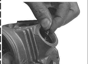
ロッカーアームのタベットスクリューを時計方向に回して取り付ける。
