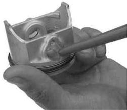
ピストンピン部とコンロッドにエンジンオイルを塗りピストンピンを取り付ける。
