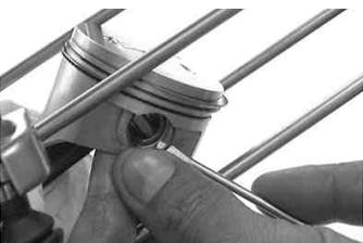
ドライバーでピストンにキズを付けないように押し込むと比較的簡単に取り付けられます。押し込み中にサークリップが外れて飛んでしまうことがあるので慎重に行ってください。目に入らぬように防護メガなどを着用して下さい。
