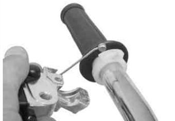
スロットルパイプからスロットルケーブルのインナーケーブルを外す。
