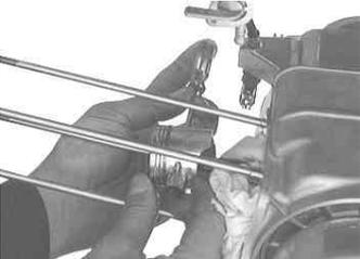
ピストンピンをピストンサークリップが付いていない方向へ取り外す。ピストンサークリップの付いている方向からマイナスドライバーで押しあげると簡単にとれます。
