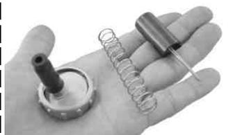
PC18キャブレターのトップキャップを外し、スプリング、スロットルバルブを抜き取る。
