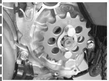
キットのプレートを取り付け、ボルト2本を仮止める。
