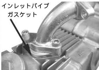
インテイクマニホールドとシリンダーヘッドにインレットパイプガスケットをはさみ、ソケットキャップスクリー6×2.5 2本で取り付け。
