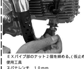
E.Xパイプ部のナット2個を締める。(仮止め)
