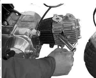
車載工具がスパークプラグレンチを使いプラグを取り付ける。
