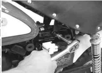
シート下にボルトを差し込み、ナットを取り付ける。
