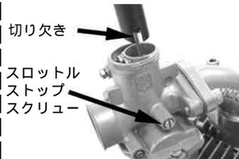
スロットルバルブの切り欠き部をスロットルストップスクリーに合わせてキャブレターに差し込み、取り付け。
