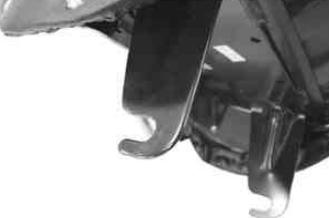
リアショックの2枚のワッシャの間にシートステーのフックを差し込み、取り付ける。
