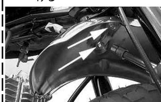
フロントフェンダー裏側の六角ボルト2本を締めて取り付ける。
