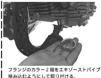
フランジのカラー2個をエキゾーストパイプを挟み込むようにして取り付ける。
