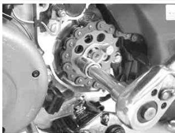
仮止めていたドライブスプロケットのボルトを本締める。
