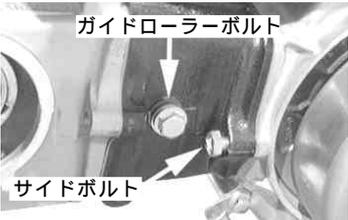
シリンダーのガイドローラーボルトとシリンダーとクランクケース間のサイドボルトを反時計方向に回しゆるめる。
