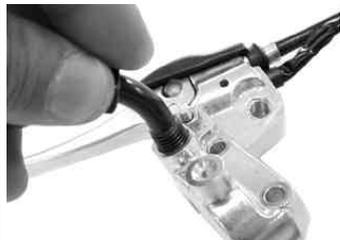
キット内のスロットルケーブルをリアスロットルハウジングに取り付ける。
