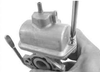
フロートチャンバーを取り付け、2本のスクリーでキャブレターに取り付けます。
