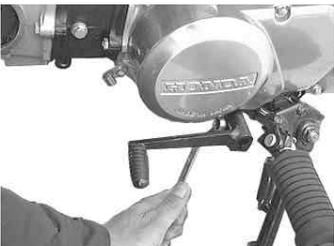
シフトペダルの6角ボルトを外しシフトペダルを反時計方向に回し取り外す。
