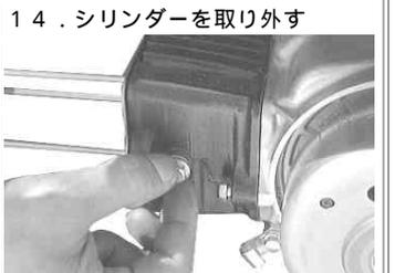
ゆるめておいたガイドローラーボルトとシリンダーサイドボルトを反時計方向に回し取り外す。
