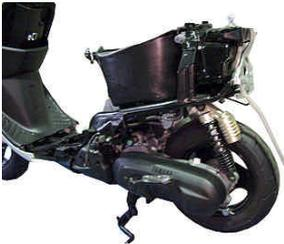
サイドカバーモール、シート、ハイマウントストップランプ、ボディーカバー、テールランプ、フットレストボードを取り外します。
