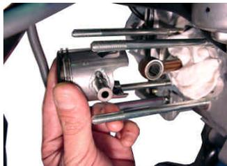
ピストンピンを抜いてピストンを外します。
