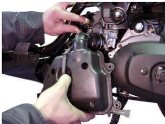
チューブを止めているクリップを外します。
