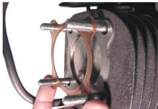
シリンダーヘッドガスケットを取り付けます。
