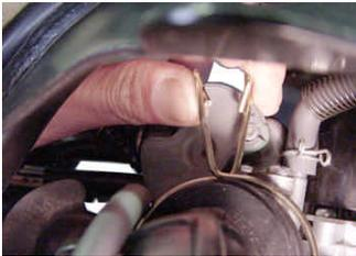
クリップで、キャブレターにチューブを取り付けます。
