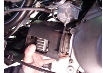
キャブレターを少し上によせながら外します。先程外したホース2本に注意しながら外して下さい。
