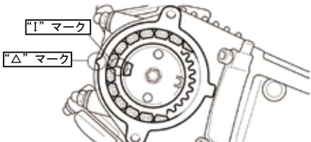
△フライホイールを保持し、カムスプロケットボルトを緩める。カムチェーンテンションナーのキャップボルトを取り外し、スプリングを取り外す。
