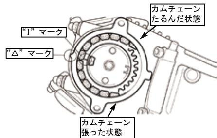
◇カムスプロケットの爪にカムシャフトの切り欠きを合わせ、ブリーザープレートとボルトを取り付ける。フライホイールを保持し、カムスプロケットのボルトを締め付ける。
