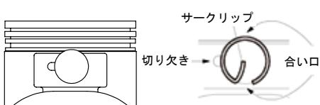
◇ピストンにピストンリングを取り付ける。
