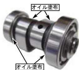
◇カム山を燃焼室側に向かって、ロッカーアームを取り付け、ストッププレートを取り付ける。
