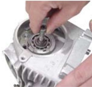
◇付属のカムシャフトのカム面、ベアリングにエンジンオイルを塗布し、ボルトを取り付け、シリンダーヘッドに取り付ける。
