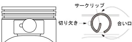
◇ピストンにピストンリングを取り付ける。オイルリングはエキスパンダを先に取り付け、後にサイドレールを取り付ける。トップリングとセカンドリングは形状、色に違いがあるので間違わないように取り付ける。
