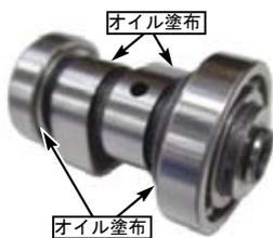
◇カム山を燃焼室側に向け、ロッカーアームを取り付け、ストッパープレートを取り付ける。
