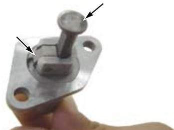
◇付属のガスケットとカムチェーンテンショナーをボルト2本でシリンダーに取り付ける。Oリング、スプリング、キャップボルトを取り付ける。
