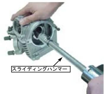
◇カムシャフトにカムプロケットのボルトを取り付けてシリンダーヘッドから抜き取る。
