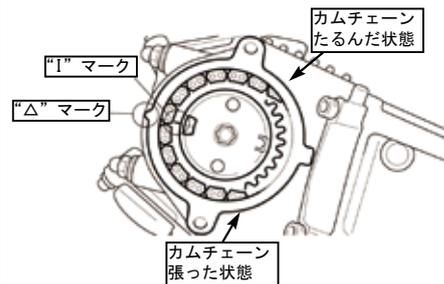
◇カムプロケットの爪にカムシャフトの切り欠きを合わせ、ブリーザープレートとボルトを取り付ける。フライホイールを保持し、カムプロケットのボルトを締め付ける。
