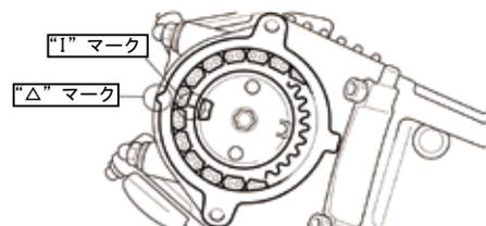
◇フライホイールを保持し、カムプロケットボルトを緩める。カムチェーンテンショナーのキャップボルトを取り外し、スプリングを取り外す。
