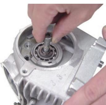
◇付属のカムシャフトのカム面、ペアリングにエンジンオイルを塗布し、ボルトを取り付け、シリンダーへッドに取り付ける。
