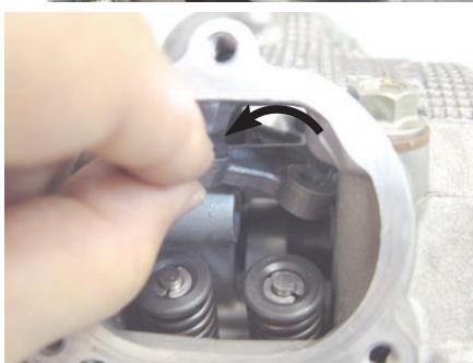
◇ノーマルのロッカーアームからアジャストナットとアジャストスクリューを取り外し、エンジンオイルを塗布しロッカーアームに仮止めする。
