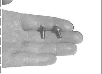
シリンダーヘッドに組み込まれているロッカーアームのタペットアジャスティングナットを緩め、タペットアジャスティングスクリューを反時計回りに回してタペットアジャスティングナットとタペットアジャスティングスクリューを一緒に外す。
