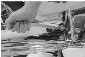
フランジ部と車体を止めるナットを締め付ける。
