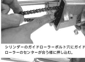
ガイドローラーボルトを取り付ける。(指で締まる程度まで仮止め)
