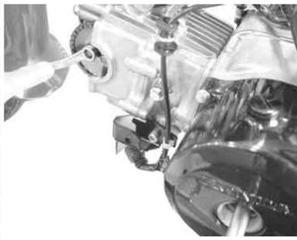
フライホイールを固定しカムスプロケット6角ボルト2個を反時計方向に回し取り外す。
