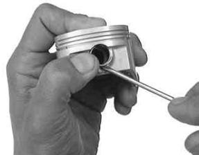
ピストンの片側に付属のピストンピンサークリップをサークリップ溝にきっちりめ込む。この時、サークリップの合い口は切り欠き部を選んで取り付ける。
