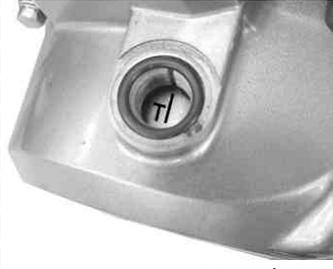
フライホイールのTマークとカムスプロケットのOマークを前方向に向け、タイミングマークをシリンダーヘッド側面に合わせ、各切り欠きに合う様にフライホイールを反時計方向に回転させて合わせる。
