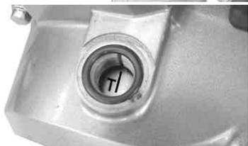
カムシャフトのOマークを前方に向け、タイミングマークをシリンダーヘッド側面に合わせ、各切り欠きに合う様に止める。磁石の反発でフライホイールはピッタリと止まらないがカムプロケットとフライホイールが同時に合えばOK。
