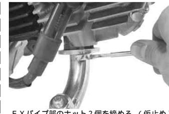
EXパイプ部のナット2個を締める。(仮止め)
