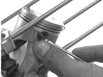
ドライバーでピストンにキズを付けないように押し込むと比較的簡単に取り付ける。サークリップの合い口は、切り欠き部を避けて取り付けてる。押し込み中にサークリップが外れて飛んでしまうことがあるので慎重に行う。△目に入らぬように防護めがねなどを着用して下さい。作業が完成すれば、詰めていたウエスを取り外す。
