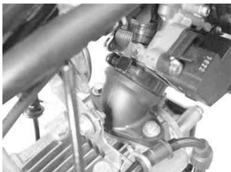
シリンダーヘッドとインレットパイプを止めているボルト2本を取り付ける。
