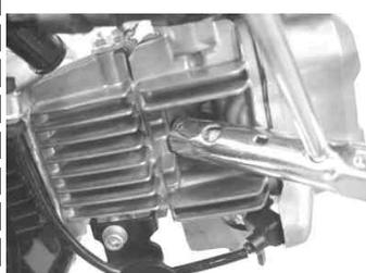
車載工具がプラグレンチを使いプラグを取り付ける。
