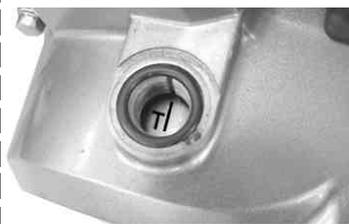
フライホイールのTマークをクランクケースの切り欠き部に合わせる。
