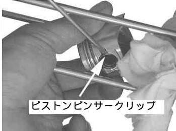
ピストンピンサークリップの片側を取り外す。ピストンピン穴の切り欠き部を利用してこじめるようにすると外れます。
