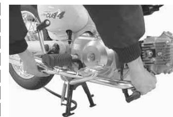
マフラーをブレーキペダルとステップの間に通し、フランジ部をシリンダーヘッドの排気出口付近まで持って行く。
