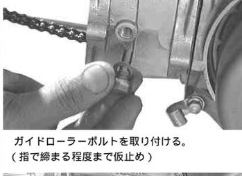
キット付属のフランジボルトM6 x 2.5を取り付ける。(指で締まる程度まで仮止め)
