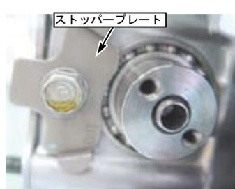
◇ノーマルのカムシャフトを外し、キット内のカムシャフトを取り外しと逆の手順で取り付け。カムシャフト・カムシャフトベアリングにきれいなエンジンオイルを塗布する。入りにくくてもハンマー等でたたかず手で入れる。
