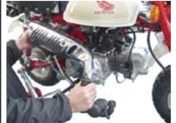
◇EXパイプ部のナット2個を締める。(仮止め)
