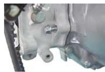
◇油温センサーを取り付け、規定トルクで締め付ける。
