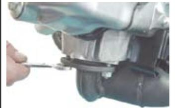
◇フランジ部と車体を止めるナットを締め付ける。
