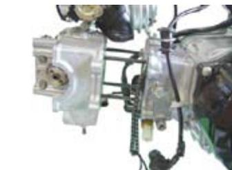
◇シリンダーヘッドプレートを組み付け、ヘッドナットを均等に締め付ける。
