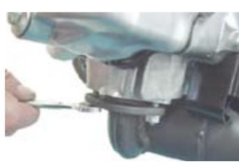
◇マフラー本体を止めている6角ボルト2ヶ所を反時計方向に回し取り外す。
