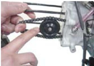
◇シリンダーのガイドローラーボルト穴にガイドローラーのセンターが合う様に押し込む。
