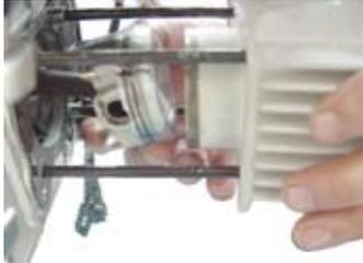
◇シリンダーをピストンリングの合い口がずれないようにしながら指で押し少しずつはめる。
