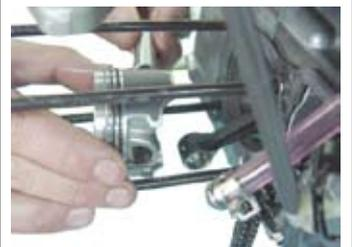
◇付属のピストンピンサークリップをサークリップ溝にきっちりはめ込む。
