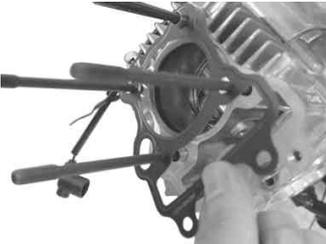
シリンダーにロックピンを取り付けヘッドガスケットを取り付ける。
