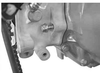
キット付属のフランジボルト 6 x 2.5 を取り付ける。(指で締まる程度まで仮止め)
