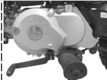
車両をレーシングスタンド等を使用して、確実に支え、ステップパーL. クランクケースカバーを取り外す。
