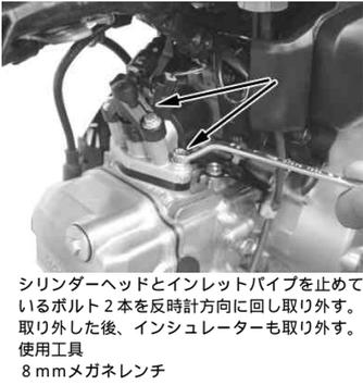
シリンダーヘッドとインレットパイブを止めているボルト2本を反時計方向に回し取り外す。取り外した後、インシュレーターも取り外す。
