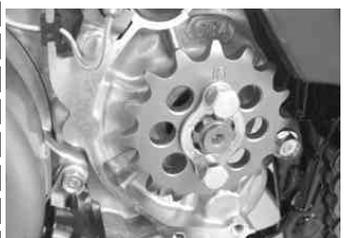
キットのプレートを取り付け、ボルト 2本を仮止める。
