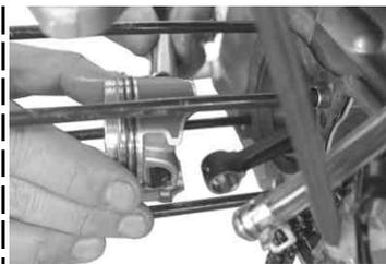
コンロッドとピストンにピストンピンを通す。付属のピストンピンサークリップをサークリップ溝にきっちりはめ込む。
