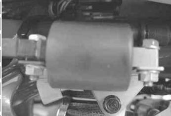
純正エアクリーナーボックスが固定されていたステーの裏側に、キット付属のフランジナット M6 を取り付け、イグニッションコイルステーを純正のマウントボルトで固定します。
