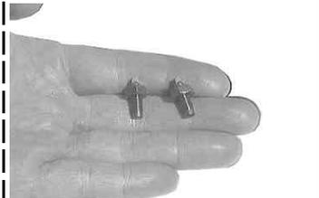
シリンダーヘッドに組み込まれているロッカーアームのタペットアジャスティングナットを緩め、タペットアジャスティングスクリューを反時計回りに回してタペットアジャスティングナットとタペットアジャスティングスクリューを一緒に外す。
