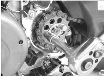
仮止めていたドライブsprocketのボルトを本締めする。
