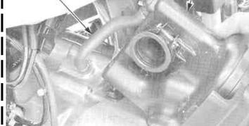
エアクリーナーケースを進行方向に対して車両左側に引き出し、クランクケースプリーザーホースの接続を外します。(純正のホースは再利用します。)
