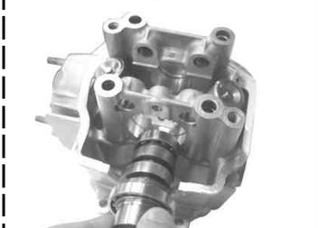
ノーマルのカムシャフトを外し、キット内のカムシャフトを取り外しと逆の手順で取り付ける。カムシャフト・カムシャフトベアリングにきれいなエンジンオイルを塗布する。入りにくくてもハンマー等でたたかず手で入れる。ノーマルカムに付いていたロックピンをキットのカムに取り付ける。
