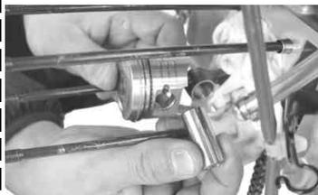
ピストンピンをピストンピンサークリップが付いていない方向へ取り外す。ピストンピンサークリップの付いている方向からマイナスドライバーで押しあげると簡単にとれる。
