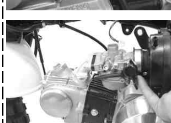
◇インレットパイプをシリンダーヘッドにとめているボルト2本を取り外しインレットパイプ、キャブレター、エアクリーナーを取り外す。
