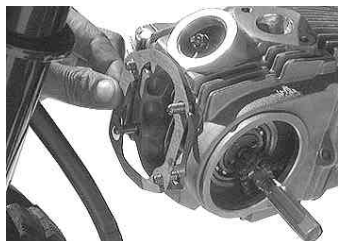
◇シリンダーヘッドカバーのガスケットとヘッドカバーを取り付ける。
