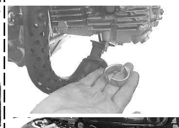
◇フランジのカラー2個を取り外し外側に引く様にしてマフラーを車体から取り外す。
