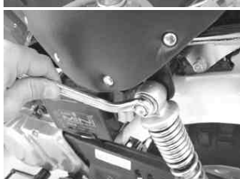
◇リアショックのナット2個をゆるめる。 使用工具 オフセットレンチ 14mm
