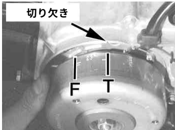
◇フライホイールのTマークをクランクケースの切り欠き部に合わせる。
