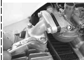
◇エアクリーナーステー部のボルトを取り外す。 使用工具 ボックスレンチ 10mm エクステンションバー 小
