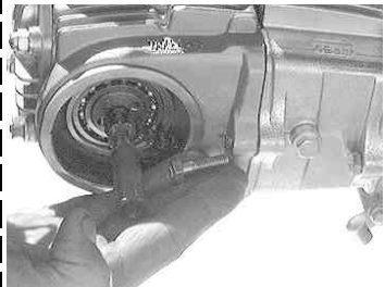
◇ヘッドサイドボルトを取り付ける。先に仮止めていたガイドローラーボルトとシリンダーサイドボルトを締め付ける。
