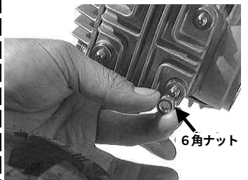
◇ヘッドカバーのワッシャとナットを取り付ける。 (エンジンを前から見て左下が銅ワッシャ残りの3つは鉄ワッシャ、右下が6角ナット残りの3つがふくろナット)
