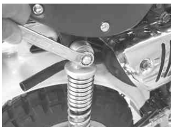
◇シート下のナットをゆるめ、ボルトを取り外す。 使用工具 ボックスレンチ 12mm エクステンションバー 小 オフセットレンチ 10mm
