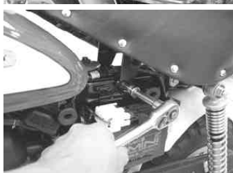
◇シート下のナットをゆるめ、ボルトを取り外す。 使用工具 ボックスレンチ 12mm エクステンションバー 小 オフセットレンチ 10mm
