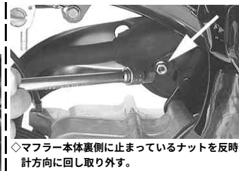
◇マフラー本体を止めている6角ボルトを反時計方向に回し取り外す。 使用工具 ボックスレンチ 12mm エクステンションバー 中
