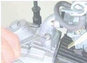
◇エアクリーナーステー部のボルトを反時計方向に回し取り外す。
