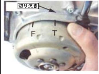
◇フライホイールを固定しカムスプロケット6角ボルト3個を反時計方向に回し取り外す。
