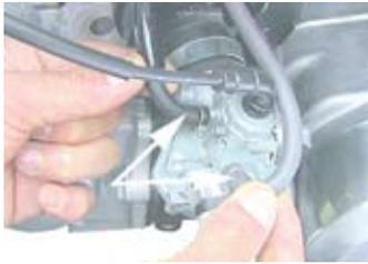
◇スロットルケーブルを取り付けたままキャブレター ASSY. を車体から離し左前方のウインカーに引っかけておく。
