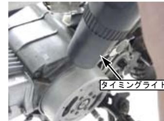
◇調整はブレーカー締め付けビスを緩め、ブレーカープレートを少しずつ動かして行う。
