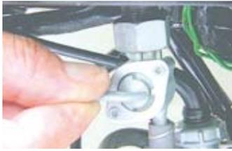
◇シリンダーヘッドとインレットパイプを止めているボルト2本を反時計方向に回し取り外す。
