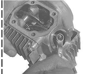
◇シリンダーヘッドに組まれているロッカーアームのタブナットとボルトを取り外す。タブナットを緩めた時点でタブボルトをナットと一緒に取り外す。
