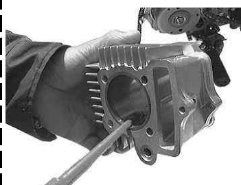
◇キットのシリンダー内にエンジンオイルを塗布し指で均等に塗り広げる。
