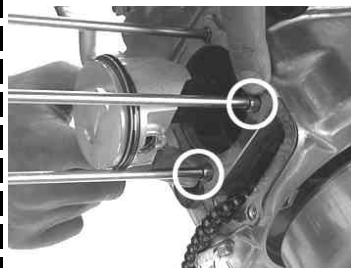
◇ノックピン2個が取り付けられているか点検。
