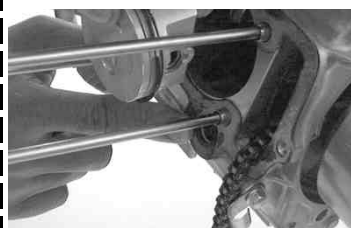
◇シリンダーベースガスケットとブラックのラバーパッキンを取り付ける。
