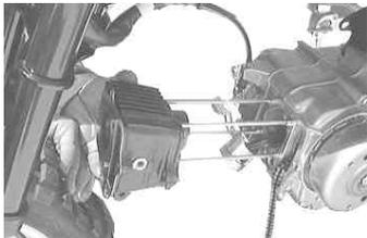
ピストンが抜けたらタイヤを手で押さえながらシリンダーを前方へ取り外す。
