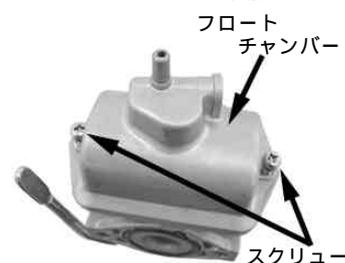
2本のスクリーを外してフロートチャンバーを取り外します。
