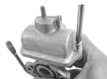
フロートチャンバーを取り付け、2本のスクリーでキャブレターに取り付けます。
