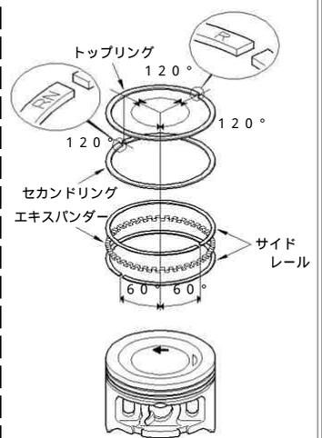
トップリングの上面にはRの刻印セカンドリングの上面にはRNの刻印があります。
