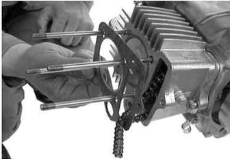
ヘッドガスケットを取り付ける。
