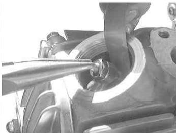
ロッカーアームのタペットスクリューを締め込んでいきタペットスクリューとバルブステムエンドの間に0.05ミリのシックネスゲージを入れて少し抵抗があるくらいで引き抜ける様に合わせてタペットナットを締め付ける(少し抵抗があるというのわからない場合0.07と0.03のシックネスゲージを用意して0.07がすぎ間に入らず0.03がゆるく入る様に合わせればだいたい0.05ミリということになる)IN・E・X共に0.05ミリに合わせる。
