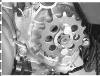
キットのプレートを取り付け、ボルト2本を仮止める。
