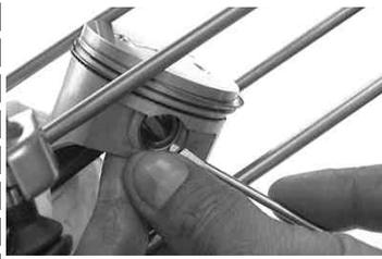
ドライバーでピストンにキズを付けないように押し込むと比較的簡単に取り付けられます。押し込み中にサークリップが外れて飛んでしまうことがあるので慎重に行ってください。目に入らぬように防護メガネなどを着用して下さい。
