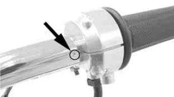
ノーマルハンドルの場合、スロットルハウジングの分割部をハンドルの"O"マークに合わせる。スロットルケーブルのワイヤリングをする。
