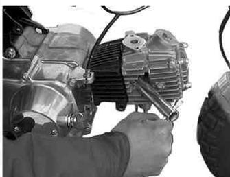
車載工具がスパークプラグレンチを使いキット内のプラグを取り付ける。
