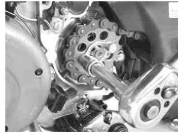
仮止めしていたドライブスプロケットのボルトを本締めする。
