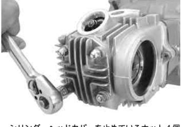
シリンダーヘッドカバーを止めているナット4個を対角の順番に反時計方向へ回し取り外す。
