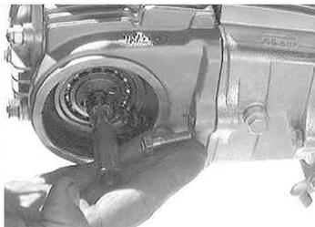
ヘッドサイドボルトを取り付ける。先に仮止めしていたガイドローラーボルトとシリンダーサイドボルトを締め付ける。
