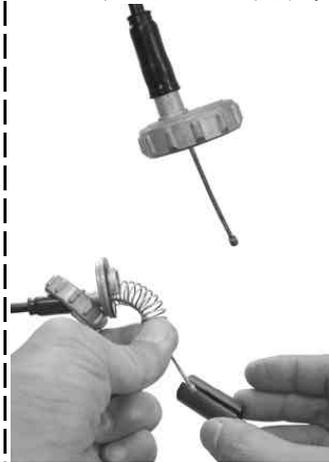
スロットルケーブルにトップキャップを取り付け、スプリングを入れてインナーケーブルにスロットルバルブを取り付ける。
