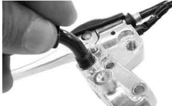
キット内のスロットルケーブルをロアスロットルハウジングに取り付ける。
