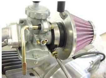
バンドをエアフィルターに付け、キャブレターに差し込む。バンドを締め付ける。
