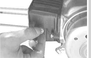
ゆるめておいたガイドローラーボルトとシリンダーサイドボルトを反時計方向に回し取り外す。
