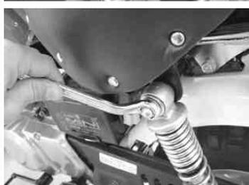
リアショックのナット2個を締め付ける。
