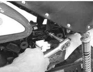
シート下のナットをゆるめ、ボルトを取り外す。
