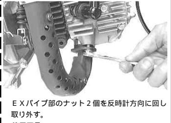
EXパイプ部のナット2個を反時計方向に回し取り外す。
