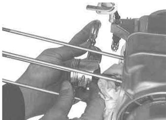
ピストンピンをピストンサークリップが付いていない方向へ取り外す。ピストンサークリップの付いている方向からマイナスドライバーで押してあげると簡単にとれます。
