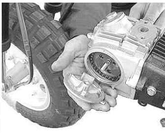
シリンダーヘッド左カバーガスケットと左カバーを取り付ける。
