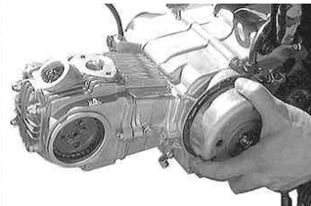
タペット調整後、反時計方向にフライホイールを2回転手で回した後でTマークとOマークを合わせる。
