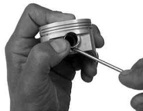
ピストンの片側に付属のピストンピンサークリップをサークリップ溝にきっちりはめ込む。この時、サークリップの合い口は切り欠き部を避けて取り付けて下さい。
