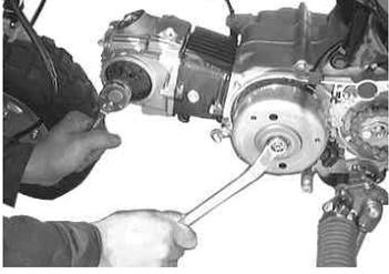
フライホイールを固定しカムスプロケット六角ボルト2個を反時計方向に回し取り外す。
