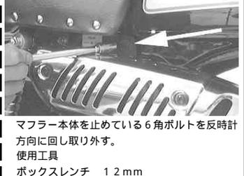
マフラー本体を止めている六角ボルトを反時計方向に回し取り外す。
