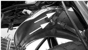
フロントフェンダー裏側の6角ボルト2本を締めて取り付ける。
