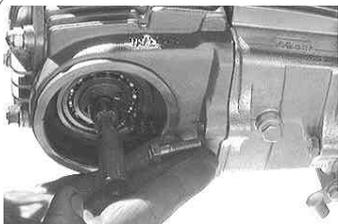
ヘッドサイドボルトを取り付ける。先に仮止めしていたガイドローラーボルトとシリンダーサイドボルトを締め付ける。
