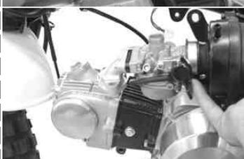
インレットパイプをシリンダーヘッドにどめているボルト2本を取り外しインレットパイプ、キャブレター、エアクリーナーを取り外す。
