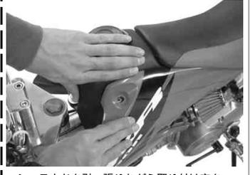
シュラウドを引っ張りながら取り付け穴をフューエルタンクのネジ穴に合わせてスクリュー2本を取り付ける。
