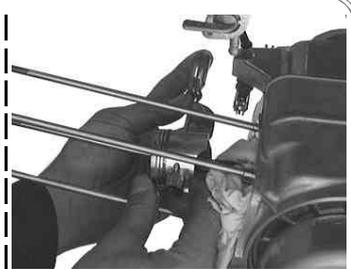
ピストンピンをピストンサークリップが付いていない方向へ取り外す。ピストンサークリップの付いている方向からマイナスドライバーで押しあげると簡単にとれる。
