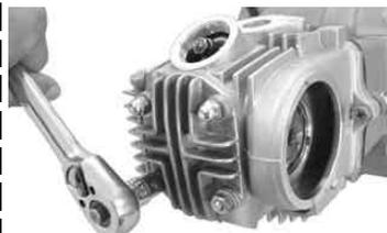
シリンダーヘッドカバーを止めているナット4個を対角の順番に取り外す。ナット下にあるワッシャ4枚を取り外す。
