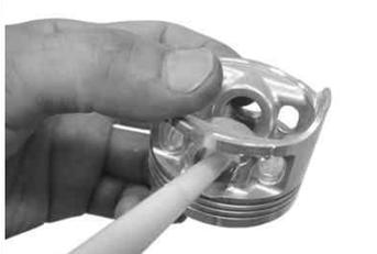
ピストンピン部とコンロッドにエンジンオイルを塗りピストンピンを取り付ける。
