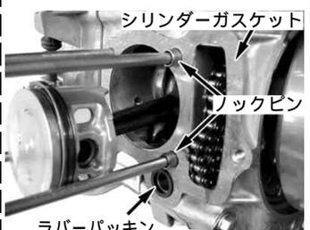
ノックピンB(長さ12mm)2個が付いているか確認し、シリンダーガスケットとラバーパッキンを1個取り付ける。
