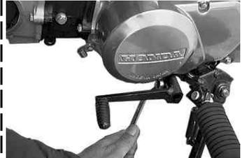
シフトペダルの六角ボルトを外しシフトペダルを取り外す。
