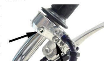
アッパースロットルハウジングを2本のスクリューで取り付ける。
