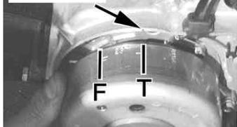
フライホイールのTマークをクランクケースの切り欠き部に合わせる。
