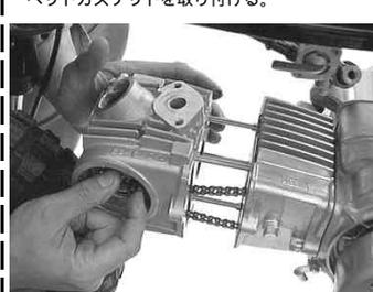
シリンダーヘッドをスタートボルトに通す。シリンダーヘッドにカムチェーンを通しながら取り付ける。
