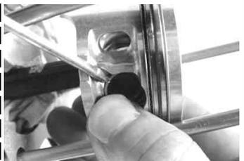
ドライバーでピストンにキズを付けないように押し込むと比較的簡単に取り付けられる。押し込み中にサークリップが外れて飛んでしまうことがあるので慎重に行うこと。
