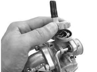
PC18キャブレターのトップキャップを外し、スプリング、スロットルバルブを抜き取る。
