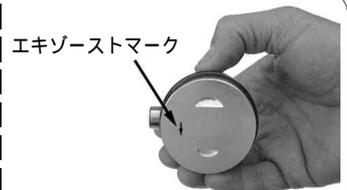
ピストンヘッド部矢印マークの先を下(エキゾースト側)になるようにしてピストンを取り付ける。
