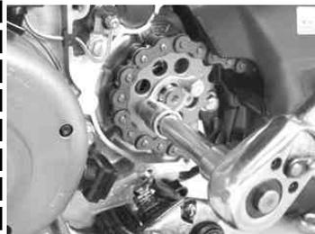
仮止めていたドライブsproケットのボルトを本締めする。
