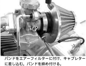
バンドをエアフィルターに付け、キャブレターに差し込む。バンドを締め付ける。
