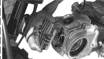
ヘッドカバーを取り外す。(かたい場合はプラスチックハンマーで軽くたたき、取り外す)シリンダーヘッドにガスケットが残った場合は、スクレーパーやカッター等できれいに取り除く。
