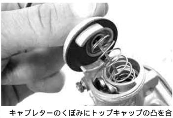
キャブレターのくぼみにトップキャップの凸を合わせて取り付ける。
