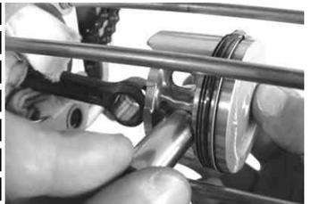
ピストンに三分の一程度ピストンピンを挿し込んで取り付けるのも簡単な方法ではある。付属のピストンピンサークリップをサークリップ溝にきっちりめ込む。
