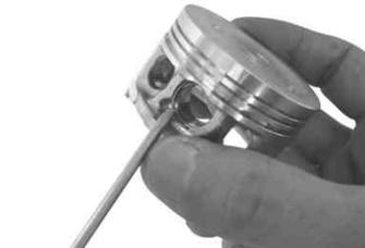
ピストンの左側に付属のピストンピンサークリップをサークリップ溝にきっちりめ込む。この時、サークリップの合い口は切り欠き部を避けて取り付ける。
