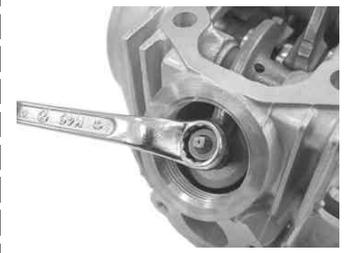
シリンダーヘッドに組み込まれているロッカーアームのタベットナットを緩め、タベットスクロを反時計回りに回してタベットナットとタベットスクロを一緒に外す。
