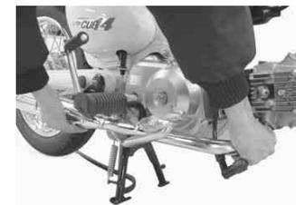
マフラーをプレーキペダルとステップの間に通し、フランジ部をシリンダーヘッドの排気出口付近まで持って行く。
