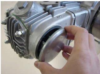
シリンダーヘッド左カバーガスケットと左カバーを取り付ける。
