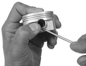
ピストンの片側に付属のピストンピンサークリップをサークリップ溝にキッチリはめ込む。この時、サークリップの合い口は切り欠き部を避けて取り付けして下さい。
