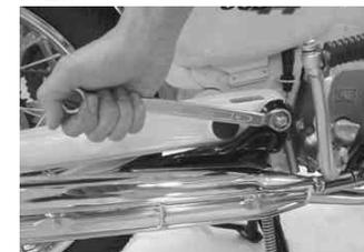
フランジ部と車体を止めるナットを締め付ける。
