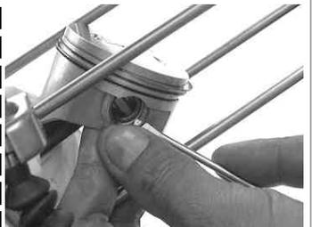
ドライバーでピストンにキズを付けないように押し込むと比較的簡単に取り付けられます。サークリップの合い口は、切り欠き部を避けて取り付けてください。押し込み中にサークリップが外れて飛んでしまうことがあるので慎重に行ってください。目に入らぬように防護めがねなどを着用して下さい。
