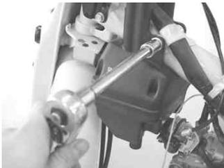
エアクリーナーのボルトを左右両側とも反時計方向に回し取り外す。
