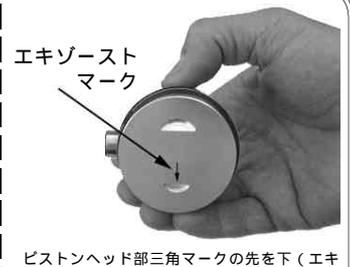
ピストンヘッド部三角マークの先を下(エキゾースト側)になるようにしてピストンを取り付ける。
