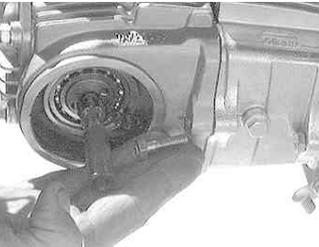
ヘッドサイドボルトを取り付ける。先に仮止め
