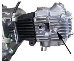
シリンダーヘッド右カバーの真ん中の6角ボルトを外すと左カバーが外れる。(ボルトを外しても外れない場合6角ボルトを2-3山ねじ込み6角ボルトの頭をハンマー等で軽くたたくと外れる)
