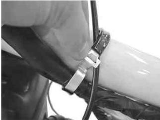
ワイヤーを束ねているベルトを外します。スロットルケーブルとチョークケーブルを取り付けたままキャブレターASSYを車体から離し左前方のウインカーに引っかけておく。
