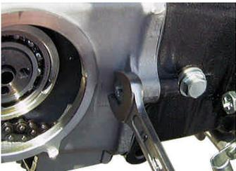
シリンダーヘッドとシリンダーを止めているシリンダーヘッドサイドボルトを反時計方向に回し取り外す。
