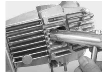
車載工具がプラグレンチを使いプラグを取り付ける。
