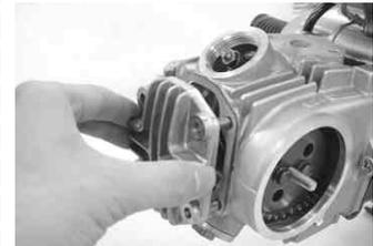
ヘッドカバーを取り外す。(かたい場合はプラスチックハンマーで軽くたたき、取り外す)シリンダーヘッドにガスケットが残った場合は、スクレーパーかカッター等できれいに取り除く。
