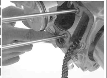
シリンダー-ガスケットとラバーパッキングを取り付ける。
