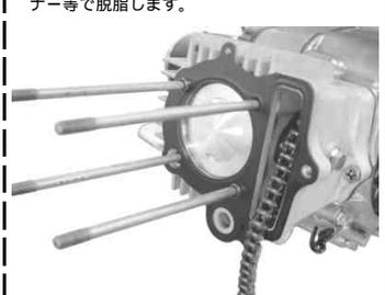
シリンダーにノックピンAを2個(長さ14mm)を取り付けます。
