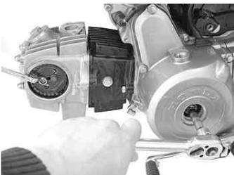
フライホイールを固定し、カムプロケットの6角ボルト2本を取り外します。
