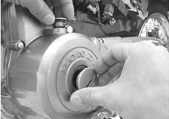
タペットホールキャップ2個とタイミングホールキャップとクランクシャフトホールキャップを取り付けます。
