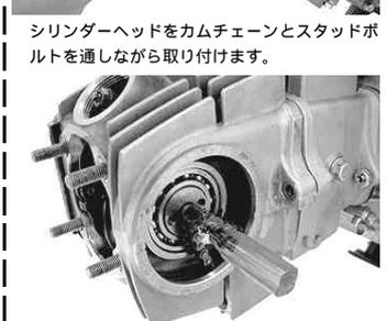
カムチェーンが落ちないようにカムシャフトにドライバー等をさしてカムチェーンを止めておきます。ヘッドカバーとシリンダーヘッドの合せ面をシナー等で脱脂します。
