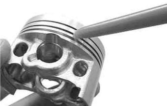
ピストンのリング溝にエンジンオイルを塗布します。
