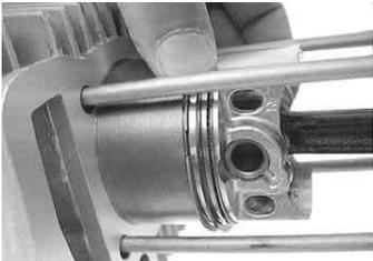
シリンダーにピストンリングの合い口がずれないように指で少しずつはめていきます。
