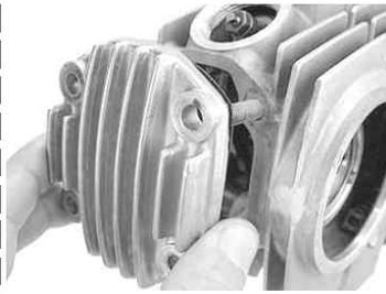
ヘッドカバーを取り外します。(かたい時はプラスチックハンマーで軽くたたき、取り外します。)
