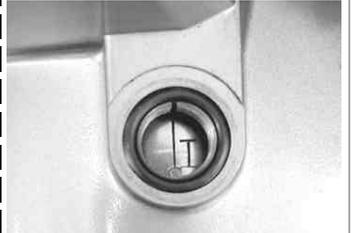
タペット調整後クランクシャフトを反時計方向に2回転、回して“T”マークと“O”マークを合わせます。
