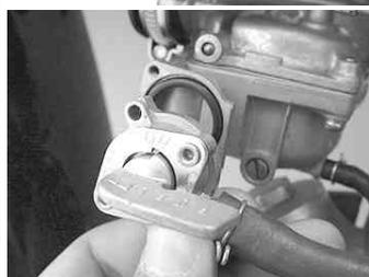
スロットルケーブルは外さずにエアクリーナーBOXの2個のボルトをゆるめ、取り外します。
