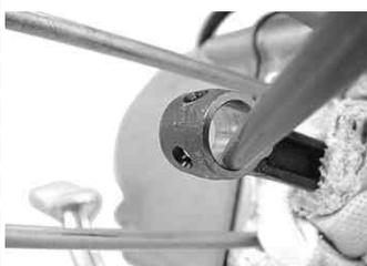
付属のピストンピンとコンロッドにエンジンオイルを塗布します。
