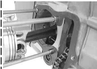
ノックピンB (長さ12mm) を2個、シリンダーガスケット、ラバーパッキン黒1個を取り付けます。
