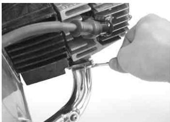
シリンダーヘッド側のナット2個を取り外します。
