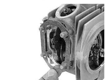
ヘッドカバーガスケットを取り付けます。
