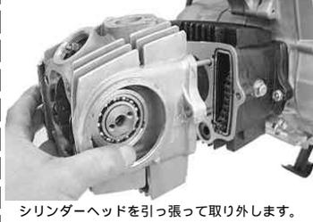
シリンダーヘッドを引っ張って取り外します。(かたい時はプラスチックハンマーでシリンダーヘッドを軽くたたき、取り外します。)
