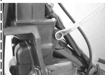
エアクリーナーBOXの左右のボルトをゆるめ、取り外します。
