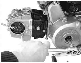
フライホイールを固定し、カムプロケットボルト2本を締め付けます。
