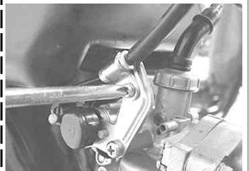
チョークケーブルを取り付け、ボルトを締めめます。
