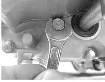
チェンベダルシャフト横に先程外した六角ボルトを取り付けます。
