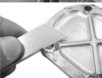
ヘッドカバーとシリンダーヘッド合せ面のガスケットカスをスクレーパーやカッターナイフ等できれいに取り除きます。取り付け面にキズを付けないように注意して下さい。
