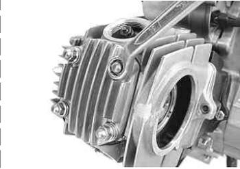
シリンダーヘッドを止めているナット4個を対角にゆるめて取り外します。
