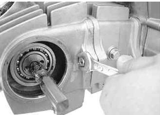
シリンダーヘッドサイドボルトを締め付けます。
