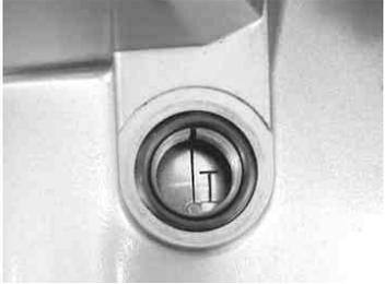
フライホイールを反時計方向に回し、“T”マークをケースカバーの切り欠き部に合せます。
