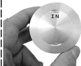
ピストンの上面のINマークをインテーク側に向くように、ピストンを取り付けます。
