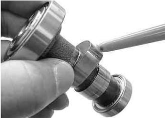
キットのカムシャフトにエンジンオイルを塗布します。カムシャフトを逆の手順で取り付けます。
