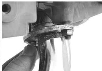
シリンダーヘッド側のナット2個を仮止めします。
