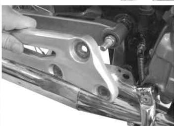
ナット1個、ボルト2本を取り外して、右のタンデムステップブラケットを取り外します。
