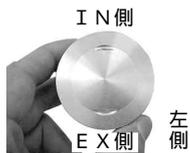
ピストンの左側に付属のピストンピンサークリップを取り付けます。ピストンピンサークリップの合い口は切り欠き部を避けて取り付けして下さい。ドライバーで、押し込むと比較的簡単に取付けることができます。ピストンにキズを付けないで下さい。
