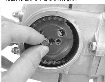
カムプロケットのボルトを手締めします。
