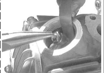
ロッカーアームのタペットスクリューを締め込んでいきタペットスクリューとバルブステムエンドの間に0.05ミリのシクネスゲージを入れて少し抵抗があるくらいで引き抜ける様に合わせてタペットナットを締め付ける(少し抵抗があるというのわからない場合0.07と0.03のシクネスゲージを用意して0.07がすき間に入らず0.03がゆるく入る様に合わせればだいたい0.05ミリということになる)IN・EX共に0.05ミリに合わせる。
