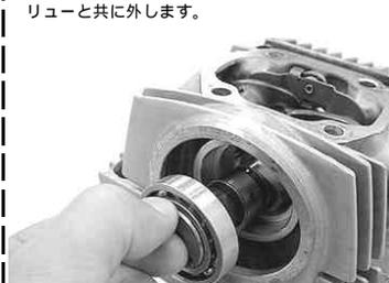
カムシャフトにカムスプロケットボルトを取り付けて引っ張るか、プラスチックハンマーでシリンダーヘッドを軽くたたくとカムシャフトは抜けません。無理に引っ張らないで下さい。
