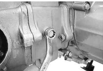
仮止めしていた、ガイドローラーボルトを本締めします。
