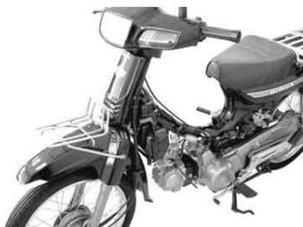
カバー、左右のサイドカバーとフロントカバーを取り外します。
