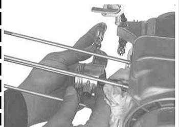
ピストンピンをサークリップを取り外した方へドライバー等で押して外します。
