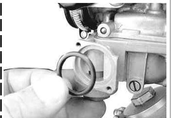
コックのOリングを取り付け、2本のボルトで取り付けます。
