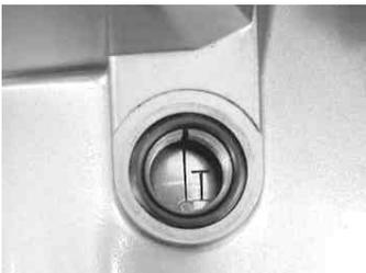
クランクシャフトを反時計方向に回して、フライホイールの「T」マークとカムプロケットの「○」マークをそれぞれの切り欠きに合わせます。
