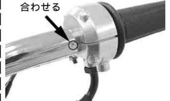
スロットルケーブルのワイヤリングをします。6角ナットを締め付けます。
