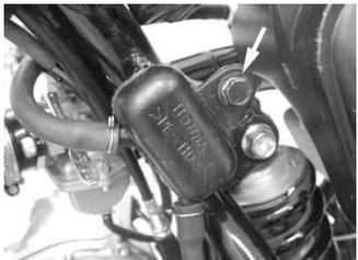
キャブレターのチョークレバーを引いて全閉にし、ストレージタンクチューブとチョークレバーが干渉しない位置にストレージタンクを動かし、ボルトを締め付けます。
