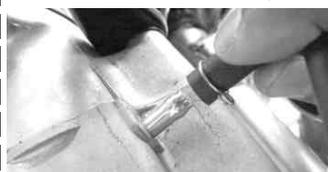
クラッチケーブルガイドのナットをゆるめ、リフターレバーからクラッチケーブルの接続を外します。
