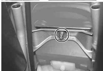
フューエルコックにフューエルチューブを接続し、チューブクリップで固定します。
