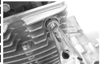
カムsprocketの六角ボルト2本を取り外します。
