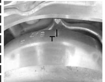
カムスプロケットの「O」マークが真上を向くようにカムチェーンを取り付けます。カムスプロケットをカムシャフトにはめ込みます。
