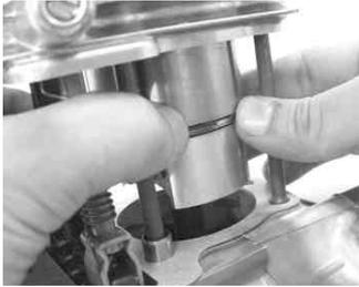
ピストンがシリンダーにはまったら、カムチェーンをシリンダーに通してシリンダーをクランクケースにはめ込みます。
