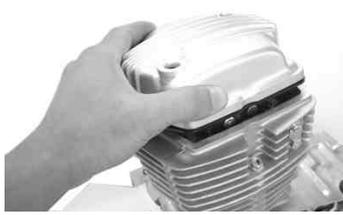
フライホイールを固定し、カムsprocketの六角ボルト2本をゆるめておきます。
