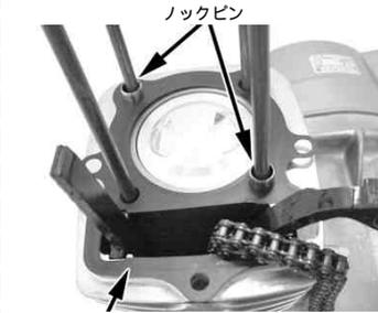
シリンダーヘッドガスケットカムチェーンをシリンダーヘッドに通し、シリンダーヘッドを取り付けます。
