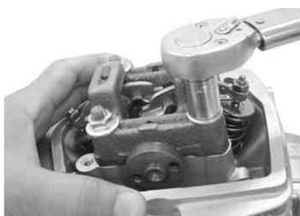
仮止めしていたシリンダーヘッドマウントボルトを本締めします。
