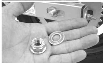
アクスルシャフトを抜き取り、リアキャリアを後方にスライドさせて取り外してからホイールを取り外します。
