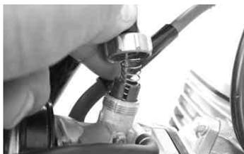
コンプレッションスプリングを圧縮してスロットルケーブルをスロットルバルブから取り外します。
