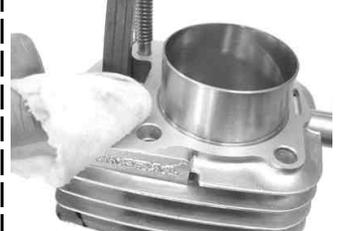
ロックピン2個とシリンダーガスケットをクランクケースに取り付けます。
