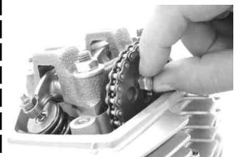
カムsprocketをカムシャフトから外し、カムチェーンを外します。
