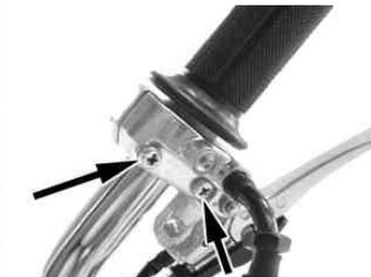
このとき、前側のスクリーを先に締め付け、後側のスクリーを後に締め付けます。
