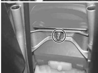
リアフェンダー後部を持ち上げ、後方にスライドさせて、シート/リアフェンダーを取り外します。
