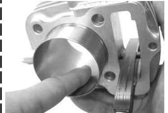
ピストンの全周面と、ピストンリングにエンジンオイルを塗布します。
