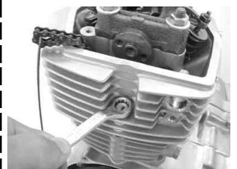
カムシャフトホルダーナット4個を対角に数回に分けてゆるめてワッシャ4個、カムシャフトホルダー、カムシャフト、ノックピンを取り外します。
