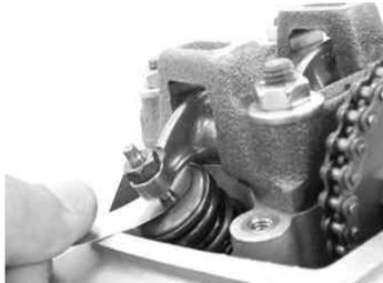
引き抜くときに少し抵抗があるぐらいにアジャストスクリューを合わせ、ナットを締め付けます。
