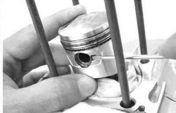
サークリップを取り外した方ヘドライバー等でピストンを押して外します。
