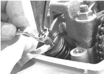
ナットを締め付け後、0.1mmのシクネスゲージを再度差し込み、バルブ隙間を確認します。シリンダーヘッドのオイル溜りにきれいなエンジンオイルをいっぱいまで入れます。
