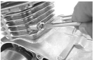
マイナスドライバーでアジャストボルトを固定し、ロックナットを締め付けます。
