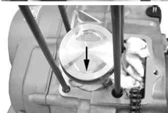
付属のピストンピンサークリップを取り付けます。
