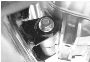
フロントエンジンハンガーを取り付け、ボルト4本を左側から差し込み、ナット4個を仮止めします。
