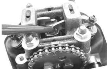
シリンダーヘッドカバーとガスケットをシリンダーヘッドカバーボルト2本でシリンダーヘッドに取り付けます。
