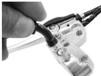
スロットルケーブルをスロットルパイプに接続します。
