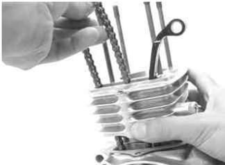
カムチェーンガイドの先端をクランクケースの溝に、突起部をシリンダーの溝に合わせるようにして差し込みます。
