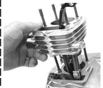
シリンダーにピストンリングの合い口がずれないように指で少しずつはめていきます。
