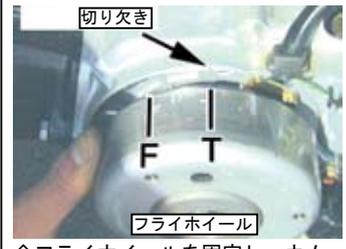
◇フライホイールを固定し、カムプロケット6角ボルト2個を反時計方向に回し取り外す。
