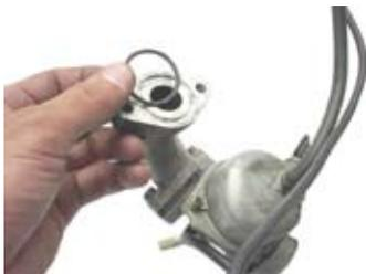
◇インレットパイプを、シリンダーヘッドに2本のボルトで取り付ける。
