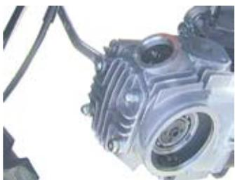
◇ヘッドカバーを取り外す。(かたい場合は、プラスチックハンマーで軽くたたき、取り外す) シリンダーヘッドにガスケットが残った場合は、スクレーパーかカッター等できれいに取り除く。
