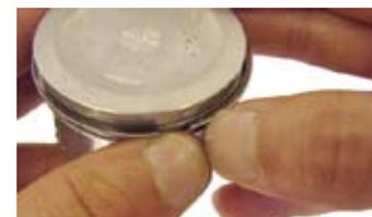
◇ピストンピン部とコンロッドにエンジンオイルを塗りピストンピンを取り付ける。
