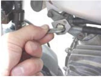
◇シリンダーヘッドとインレットパイプを止めているボルト2本を反時計方向に回して取り外す。
