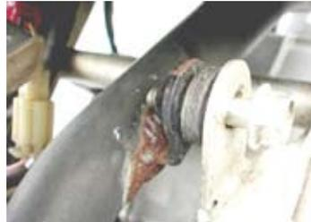
◇エキゾーストパイプをシリンダーヘッドに止めている2個のナットを反時計方向に回して取り外す。
