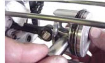
◇付属のピストンピンサークリップをサークリップ溝にきっちりはめ込む。この時、サークリップの合い口は切り欠き部を避けて、ピストン上下方向に向けて取り付け。
