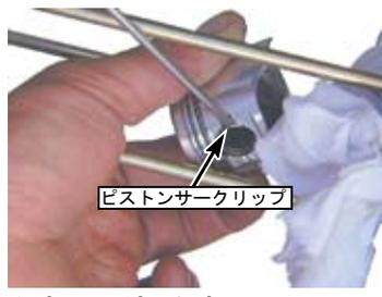
◇ピストンピンをピストンサークリップが付いていない方向へ取り外す。ピストンサークリップの付いている方向からマイナスドライバーで押すと簡単にとれる。
