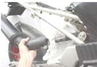
◇エキゾーストパイプをフレームに止めているボルトを反時計方向に回して取り外す。
