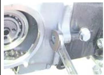
◇シリンダーのガイドローラーボルトとシリンダーとクランクケース間のサイドボルトを反時計方向に回し緩める。
