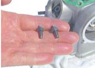
◇ロッカーアームシャフトに8mmのボルトをねじ込み、ロッカーアームシャフトを抜いて、ロッカーアームを取り出す。
