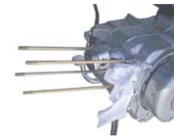
◇ピストンサークリップの片側を取り外す。
