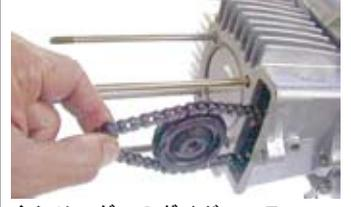
◇シリンダーのガイドローラーボルト穴にガイドローラーのセンターが合う様に押し込み、シーリングワッシャとガイドローラーボルトを取り付ける。(指で閉まる程度まで仮止め)
