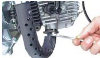
◇エキゾーストパイプをフレームから抜き取る。
