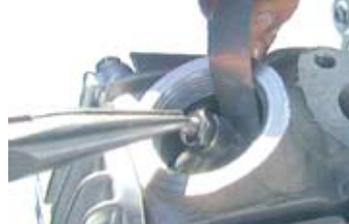
◇タペット調整後、反時計方向にフライホイールを2回転手で回した後でTマークとOマークを合わせる。
