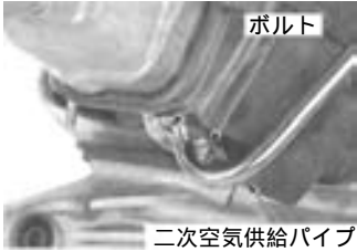
ボルト 二次空気供給パイプ
