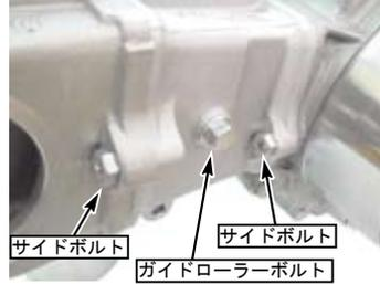
◇付属の⑩R. シリンダーヘッドサイドカバーガasketと共にR. シリンダーヘッドサイドカバーを取り付け、2本のボルトを規定トルクにて締め付ける。
