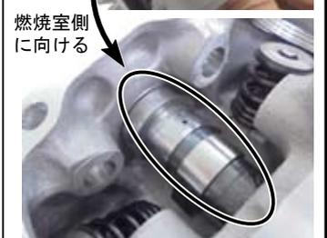
◇シリンダーヘッドに付属の⑪ ストッパープレート、付属の⑫ ロッカーアーム2個、ロッカーアームシャフトを取り付ける。
