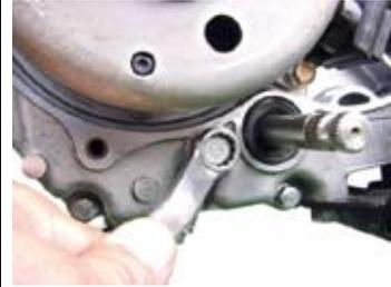
◇フライホイールを反時計方向に回し、“T”マークを切り欠き部に合わせる。
