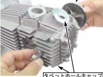
◇推奨するスパークプラグを取り付け、プラグキャップを取り付ける。
