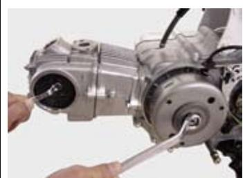
◇クランクシャフトを反時計方向に回し、フライホイールの“T”マークを切り欠き部に合わせた際、カムプロケットの“O”マークがシリンダーヘッドの切り欠きと合う事を確認する。
