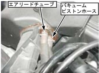
◇取り外した後の口にゴム系接着剤を塗布し、上側にキャップ7mm、下側にキャップ9.8mmを取り付ける。
