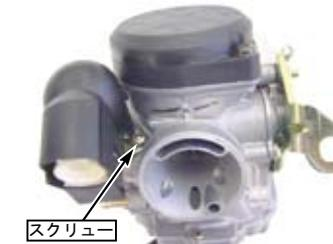
◇ノーマルのキャブレターからフューエルチューブを外し、キットのキャブレターに取り付ける。
