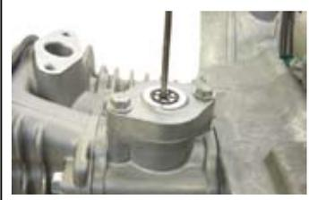
◇カムチェーンテンショナーの溝に0リングが付いているのを確認し、スクリューをカムチェーンテンショナーに取り付ける。
