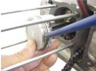
◇シリンダーをピストンリングの合い口の位置がずれないように指で少しずつピストンにはめていき、シリンダーをクランクケースにはめ込む。
