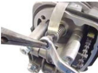
◇フライホイールを時計方向に2回転まわし、バルブ隙間が変化していないか確認する。隙間が変化している場合は再度調整する。この作業を合うまで繰り返す。
