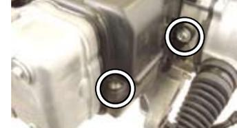
◇ファンカバーをはめ、シュラウドにスクリュー2本で、クランクケースにボルト2本で取り付ける。
