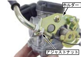
◇キャブレターのスロットルドラムを回し、スロットルケーブルのインナーを取り付ける。
