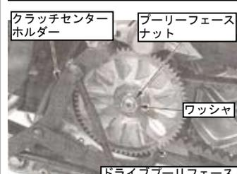
◇ムーバブルドライブフェースを、裏側のランププレートを押さえウエイトローラーが落下しないよう注意しながら、ドライブフェースボスと共に取り外す。
