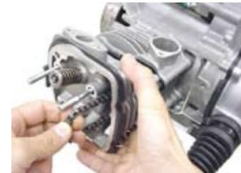
◇シリンダーヘッドにノックピン2個を取り付け、カムシャフトホルダーを取り付ける。
