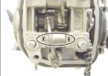
◇ナット4個、ボルト2本を仮止めておき、先にナットを対角線状になるように数回に分けて締め付ける。
