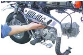
◇フランジのカラー 2 個をエキゾーストパイプを挟み込むようにして取り付ける。
