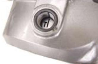
◇ロッカーアームのアジャストスクリューとバルブシステムエンドの間に0.05ミリのシクネスゲージを入れてアジャストスクリューを締め込んでいき、少し抵抗があるくらいでシクネスゲージが引き抜ける様に合わせてアジャストナットを締め付ける（少し抵抗があるというのがわからない場合0.07と0.03のシクネスゲージを用意して0.07がすき間に入らず0.03が緩めに入る様に合わせれば、だいたい0.05ミリという事になる）IN、EX共に0.05ミリに合わせる。
