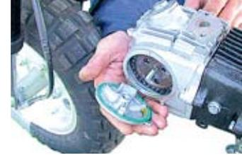
◇シフトペダルの 6角ボルトを外しチェンジペダルを取り外す。
