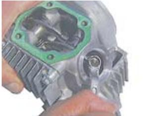
◇カムシャフトにカムプロケットボルトを取り付け、引っ張るかプラスチックハンマーでヘッドを軽くたたくと抜けてくるので無理に引っ張らずカムシャフトを回しながら取り外す。
