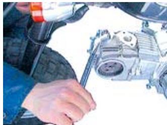
◇シリンダーヘッド左サイドカバーガスケットと左サイドカバーを取り付ける。（左サイドカバーの回り止めを合わせる）
