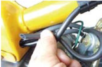
◇ストレージタンクにブリーザーホース（フレームNo. AA01の車両の場合）を取り付ける。
