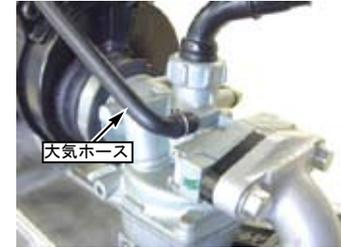
2. ◇ストレージタンクのホース（フレームNo. AB27-の車両の場合）を抜き取る。
