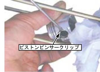
◇ピストンピンをサークリップが付いていない方向へ取り外す。サークリップの付いている方向からマイナスドライバーで押すと簡単にとれる。
