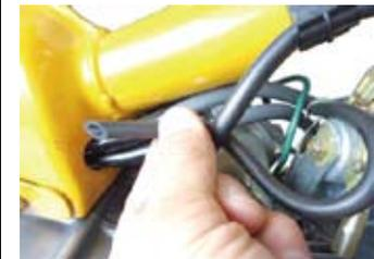
◇ストレージタンクにつながるブリーザーホース（フレームNo. AA01の車両の場合）を抜き取る。
