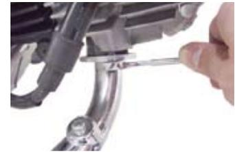
◇フランジ部と車体を止めるナットを締め付ける。
