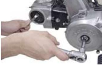
◇先程、取り外したチェンジペダルシャフト横のボルト穴にエンジンオイルを少量注入し、6角ボルトとシーリングワッシャを取り付ける。
