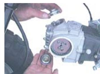
◇フライホイールの T マークとカムプロケットの 0 マークが各切り欠きに合う様にフライホイールを反時計方向に回転させて合わせる。
