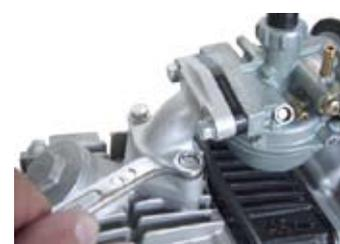
◇エアクリーナーステー部のボルトをアース線と共締めで取り付ける。(下図参照)
