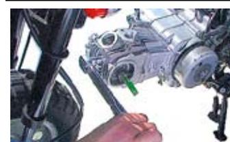
◇シリンダーヘッドのサイドボルトを取り付け、仮止めたガイドローラーボルトとシリンダーのサイドボルトも締め付ける。
