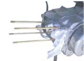
◇ピストンピンサークリップの片側を取り外す。
