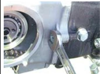
◇シリンダーのガイドローラーボルトとシリンダーとクランクケース間のサイドボルトを緩める。
