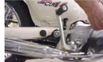
◇マフラーを外側に引く様にして車体から取り外す。この時、ステー部のカラーとヘッド部のリング状のマフラーガスケットを無くさないように注意する。
