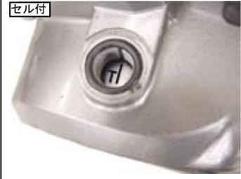
◇カムプロケットボルト穴をシリンダーヘッドの切り欠き方向に向けた時、カム山がピストン側を向く様にカムシャフトをセットする。それがカムシャフトの圧縮上死点となる。
