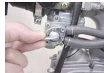
◇ドレンコックを開き、フロートチャンバーからガソリンを受け皿に抜き取る。
