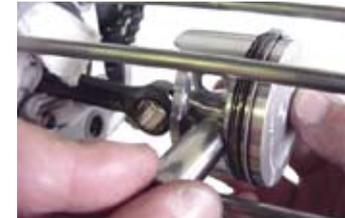
◇付属のピストンピンサークリップをサークリップ溝にきっちりはめ込む。この時、サークリップの合い口は切り欠き部を避けて、ピストン上下方向に向けて取り付け。
