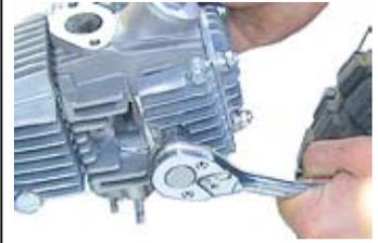
◇クランクケース左カバーを止めているボルト3本を取り付ける。
