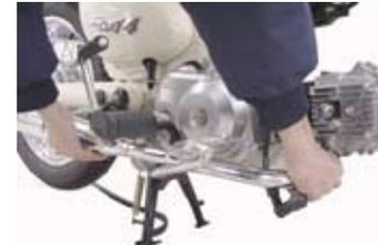
◇EX パイプ部のナット 2 個を締める。(仮止め)
