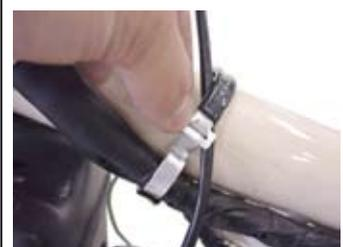
◇スロットルケーブルとチョークケーブルを取り付けたままキャブレター ASSY. を車体から離し左前方のウインカーに引っかけておく。
