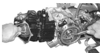
カムプロケットを取り外す。シリンダのカムチェーンテンショナのボルトを取り外しておく。
