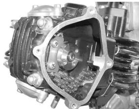
ロッカーアームを手で持ち、ロッカーアームシャフトを引き抜いてIN側、EX側のロッカーアームを取り外す。
