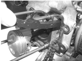
シリンダの内側にエンジンオイルを塗布し、均等に薄く塗り広げる。ピストンの全周面と、ピストンリングにエンジンオイルを塗布する。
