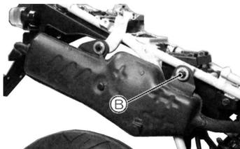
ナット 2 個とボルト 2 本を締め付ける。
