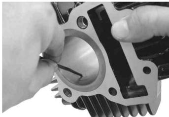
シリンダをピストンリングの合い口の位置がずれないように指で少しずつピストンにはめていき、シリンダをクランクケースにはめ込む。
