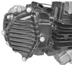
ボルト2本を取り外し、バルブアジャスティングカバー I N側、EX側をそれぞれボルト2本で取り付ける。
