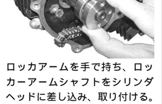
ロッカーアームを手で持ち、ロッカーアームシャフトをシリンダヘッドに差し込み、取り付け。
