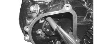
ロッカーアームシャフトストッパをスクリュー2本で取り付ける。使用工具 プラスドライバー大
