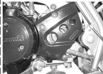
エンジンオイルドレンプラグボルトとガスケットを取り付ける。
