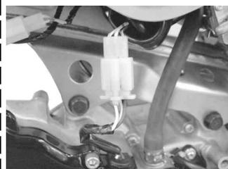
ボルト9本を取り外し、ゼネレータカバーを取り外す。ノックピンは再使用するので取り外しておく。
