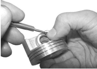
ピストンピンサークリップの合い口は切り欠き部を避けて取り付けること。
