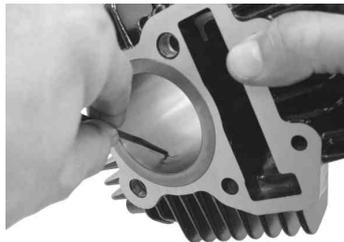
シリンダーをピストンリングの合口口の位置がずれないように指で少しずつピストンにはめていき、シリンダーをクランクケースにはめ込む。シリンダーがピストンにはまったら、カムチェーンをシリンダーに通しておく。
