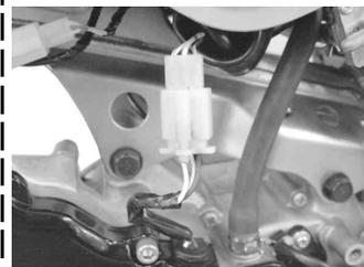
ボルト9本を取り外し、ジェネレーターカバーを取り外す。ロックピンは再使用するので取り外しておく。
