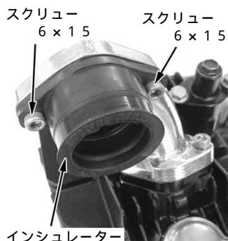
キャブレタをインシュレーターに差し込み、バンドを締め付けて固定する。
