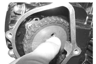
カムシャフトスプロケットの穴にカムシャフトのネジ穴を合わせ、スクリュー2本を取り付ける。
