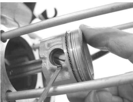
ピストンピン穴の切り欠き部を利用してこじめるようにすると外れやすい。クランクケース内に入らないように注意。
