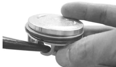
ピストン頂面の“ ”マークを下側（排気側）に向けてコンロッドに取り付ける。
