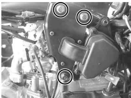
エアクリーナーボックスステー部のボルトを取り外し、ジョイント部のバンドを緩めエアクリーナーボックスを取り外す。
