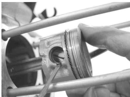
ピストンピン穴の切り欠き部を利用してこじると外れやすい。クランクケース内に入らないように注意。ピストンピンをサークリップを取り外した方へドライバー等で押して外し、ピストンを外す。
