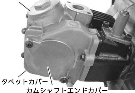
フライホイールを反時計方向に回し、カムスプロケットの合わせマークがシリンダヘッドの合わせマークに合う状態にする。これを圧縮上死点という。
