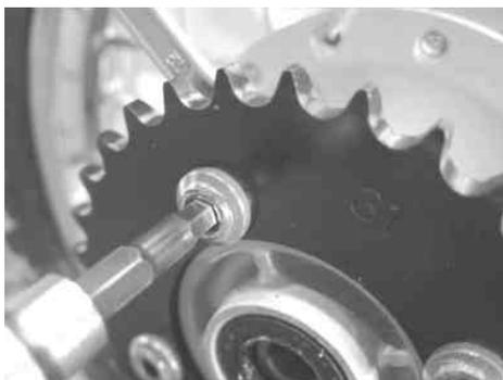
チェーンアジャスターを両サイドに挟むようにし、リアホイールを取り付け、アクスルナットを仮締めする。
