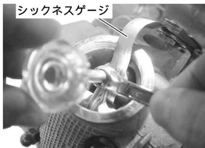
フライホイールを反時計方向に2回転回して再び圧縮上死点にし、クリアランスが変化していないか確認する。クリアランスが変化している場合は再度調整する。
