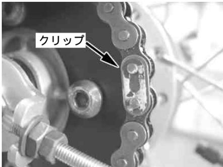
リンクプレート、マスターリンクを取り外し、スプロケットからドライブチェーンを取り外す。
