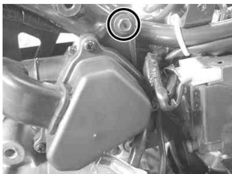
キャブレターからヒーターリードコードの接続を外し、ピニールテープ等を使用し絶縁しておく。
